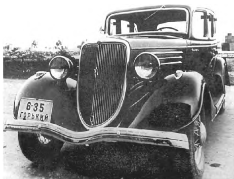
Опытный экземпляр № 3, имевший еще одну разновидность оформления капотных боковин, изначально тоже комплектовался опсицованными колесами. Весна 1935 года.
