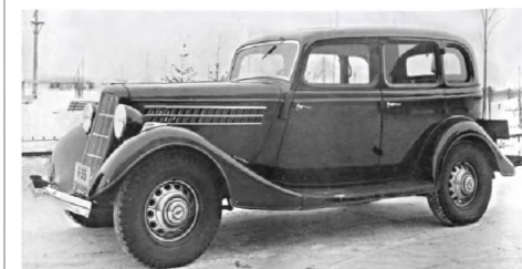
Зимой 1935 - 1936 годов, при освоении серийного производства ГАЗ М-1, элементы этой внешности еще раз пересмотрели: диски и колпаки колес, облицовка, капотные лувры и некоторые другие элементы вновь претерпели изменения в сторону большей технологичности и простоты производства.
