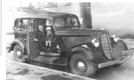
Зимой 1935 - 1936 годов, при освоении серийного производства ГАЗ М-1, элементы этой внешности еще раз пересмотрели: диски и колпаки колес, облицовка, капотные лувры и некоторые другие элементы вновь претерпели изменения в сторону большей технологичности и простоты производства.
