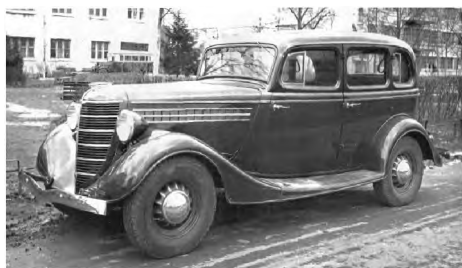
Серийный ГАЗ-11-73 – более мощная «эмка» с новой облицовкой и иными капотными луврами. 1939 год.
