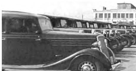
Третий опытный экземпляр М-1 во главе шеренги стандартных фазтонов ГАЗ-А. Здесь машина уже укомплектована дисковыми колесами. Лето 1935 года.
