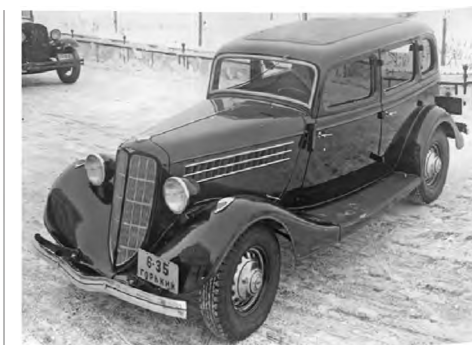
К ноябрю 1935 года третий экземпляр оснастили видоизмененной облицовкой радиатора и капотными боковинами с пластинами и луврами. Но и это была еще лишь предсерийная внешность. Ноябрь 1935 года.
