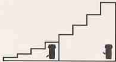
R 61 - basisversnellingsbak met range-gedeelte met twee overbrengingsverhoudingen, dat in - en uitgeschakeld wordt met een tuimelschakelaar op de ver-
