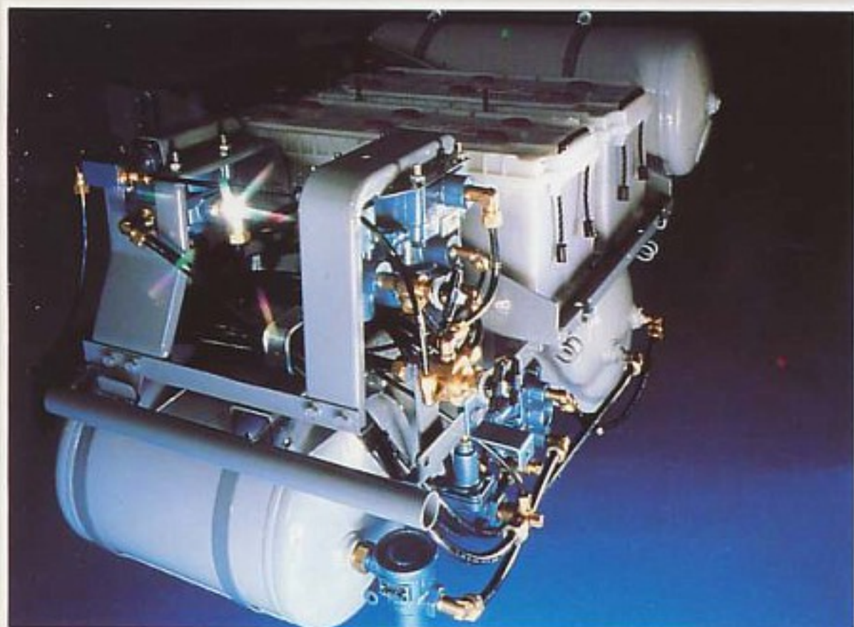
De lucht tanks en remventielen zijn dicht bij elkaar geplaatst.
