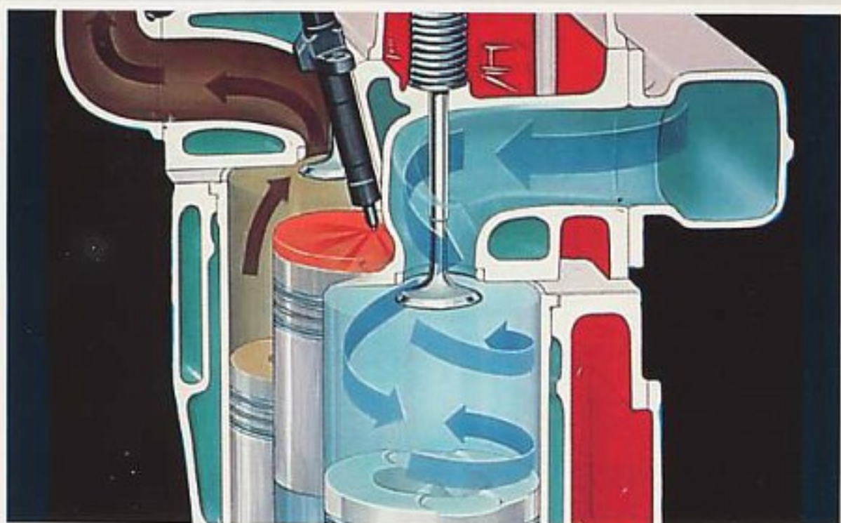
Een korrekt samengesteld brandstof/luchtmengsel.
