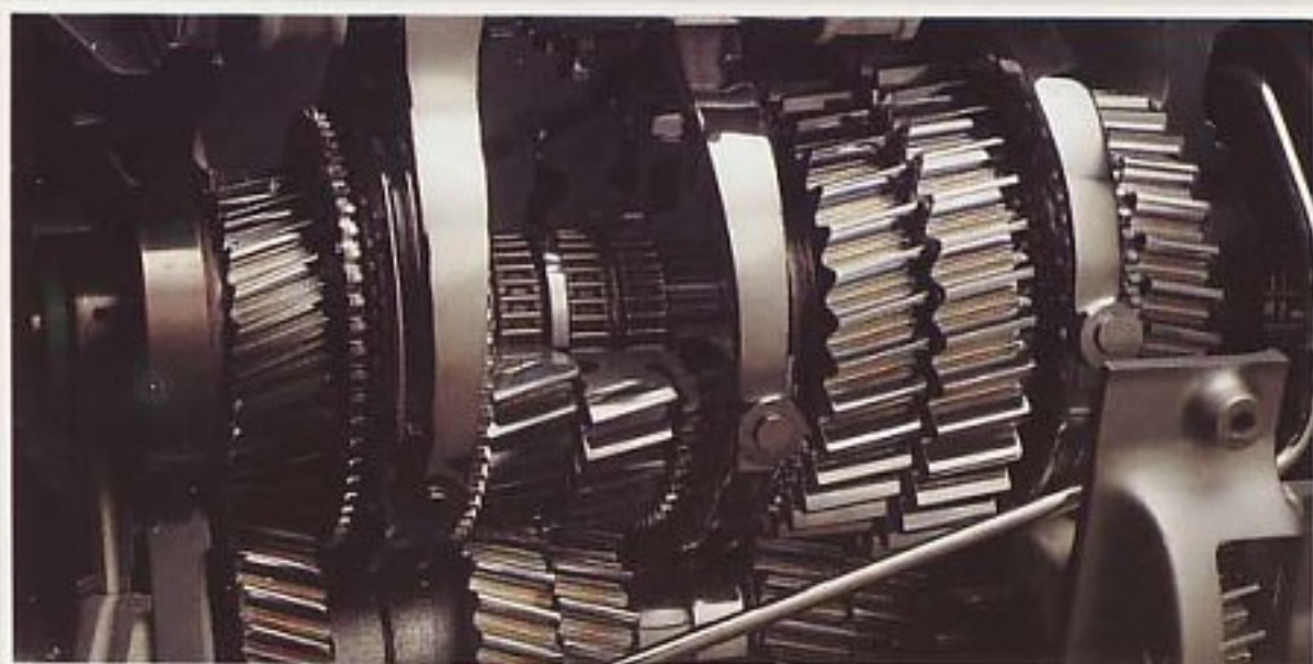
6 mm bredere tandwielen zijn berekend op sterkere aandrijfkraften.
