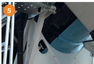
5 Сервисный замок блокировки вращения барабана и задний пластиковый защитный экран.
