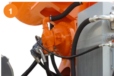
1 Водяной насос на редукторе.
