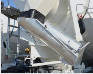
Складной разгрузочный лоток (1200 мм + 600 мм).
