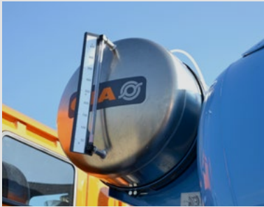
Алюминиевый бак для воды под давлением (объем от 200 л до 950 л).
