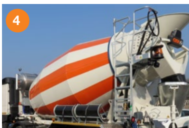
4 Лестница из оцинкованной стали.
