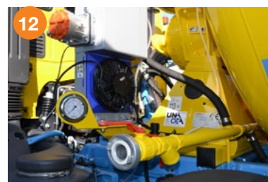
12 2 гидрантных соединения для наполнения водой с 2-х сторон. Масляный радиатор со встроенным гидравлическим баком. Манометр для измерения плотности бетона.
