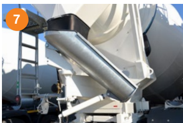
7 Разгрузочный лоток из оцинкованной стали. Одинарный, длина 1200 мм.
