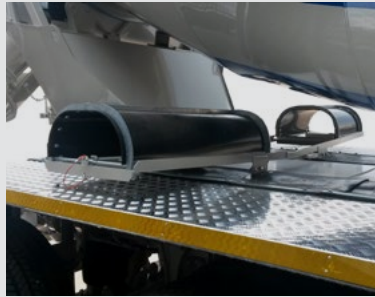
Специальные держатели удлинителей разгрузочного лотка, расположенные под 90° под барабаном.
