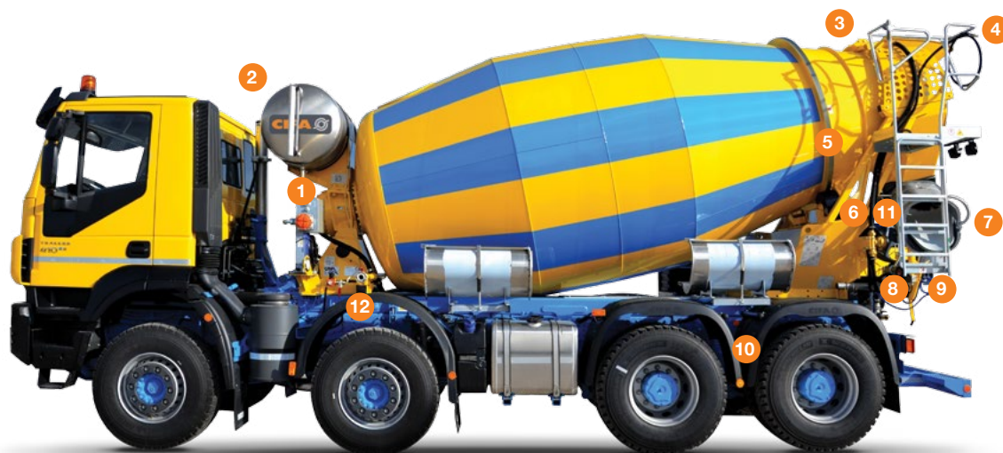
12 2 гидрантных соединения для наполнения водой с 2-х сторон. Масляный радиатор со встроенным гидравлическим баком. Манометр для измерения плотности бетона.
