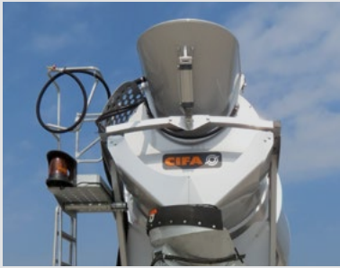
Система затвора барабана EKOS и задний проблесковый маячок.
