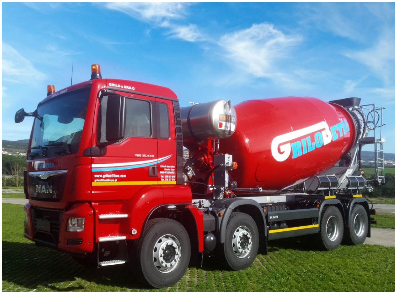
SL 12 Алюминиевый бак для воды под давлением (опция).
