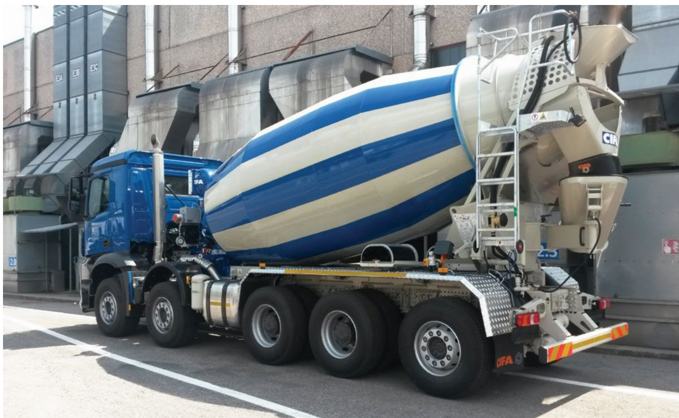
SL 12 Алюминиевые крылья для задних строенных осей (тридем) (опция), одинарная опора разгрузочного лотка, расположение панели управления с задней левой стороны, специальные держатели удлинителей разгрузочного лотка, расположенные под 90° под барабаном, прямая задняя стенка загрузочного желоба
