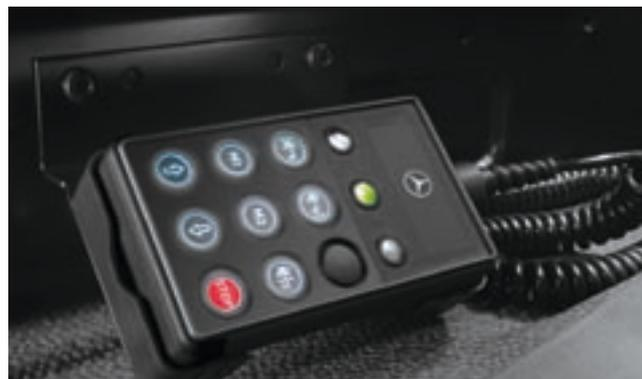
Система регулирования уровня Telligent® для поднятия и опускания рамы, входящая в стандартную комплектацию автомобилей с пневматической подвеской, позволяет легко и быстро заменить полуприцеп и приспособление для съема кузова. Новинка: теперь панель управления имеет подсветку, что облегчает процесс использования и управления панелью в темноте.
