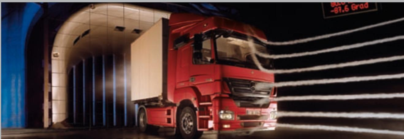
При движении на дальние расстояния с обычной скоростью в 80 – 85 км/ч 50 % топлива расходуется на преодоление сопротивления ветра. Поэтому Actros и Axor обладают совершенной аэродинамикой: начиная с переднего обтекателя, боковых дефлекторов и заканчивая верхним регулируемым аэродинамическим спойлером и закрылками.
