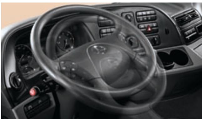
Положение руля регулируется по высоте до 66 мм и наклону от 10° до 42°. В сочетании с регулировкой сиденья водитель сможет выбрать оптимальное рабочее положение. Если угол наклона составляет 10°, парковочное положение руля облегчает посадку и выход из автомобиля, а также проход на место пассажира.
