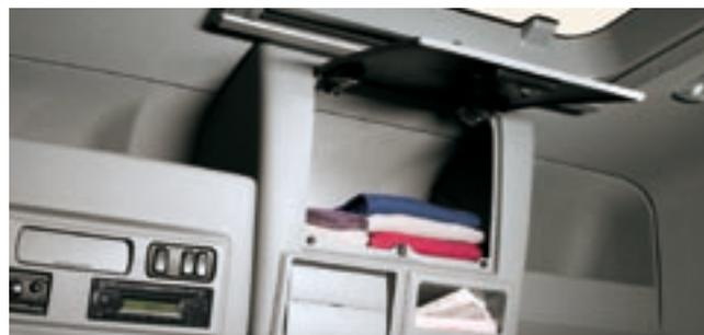
В высокой кабине L дополнительное пространство для размещения вещей образуется благодаря расположенному над ветровым стеклом просторному ящику с откидной крышкой и открытому отсеку.
