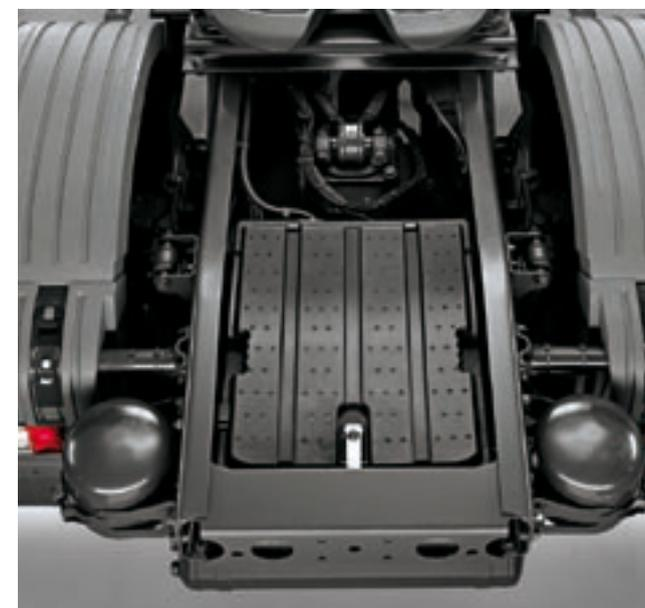
Интегральная задняя часть кузова, входящая в сочетании с кабиной Megarace в стандартную комплектацию, оптимально использует доступное ей конструктивное пространство: на седельных тягачах с пневматической подвеской с колесной базой 3600 и 3900 мм возможно размещение бака объемом до 1200 л; упрощается также монтаж гидравлического насоса или компрессора.
