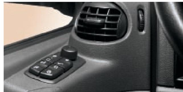
Панель управления возле двери включает в себя выключатели электроподъемников стекол, выключатели настройки зеркал и их обогрева, а также системы замков центрального управления. Круглая воздушная форсунка с различными возможностями настройки повышает безопасность и комфорт. Например, предотвращает запотевание боковых стекол.
