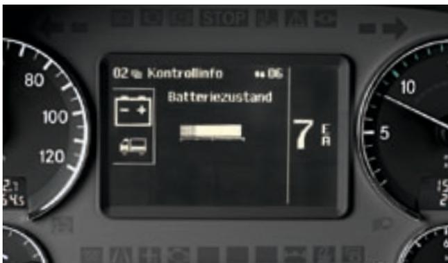
Новый входящий в стандартную комплектацию прибор, информирующий водителя о состоянии аккумуляторной батареи, позволяет осуществлять постоянный контроль заряда аккумулятора и возможности запуска двигателя. Таким образом, можно избежать незапланированных стоянок. Прибор индикации состояния аккумулятора будет доступен предположительно с 12/2008г.
