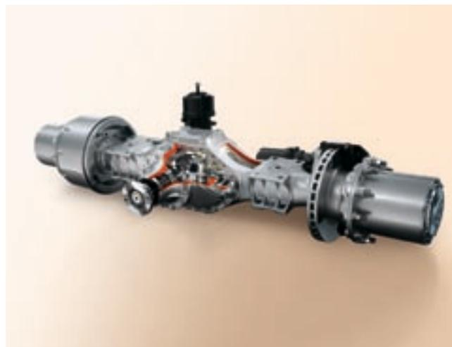
Благодаря заднему гипоидному мосту с одноступенчатой передачей HL 6 и шестнадцатиступенчатой коробке передач с прямой передачей расход топлива на высшей передаче особо низок. Прочный мост с планетарными колесными передачами HL 7 доступен на автомобилях мощностью от 265 кВт (360 л.с.).
