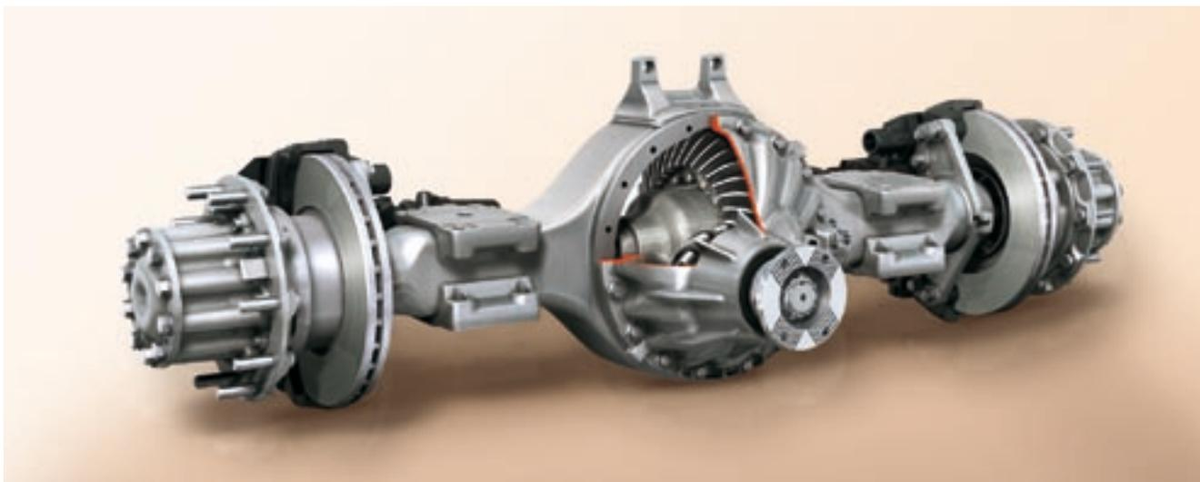
Легкий и эффективный: оптимизированный по массе гипоидный задний мост с одноступенчатой передачей HL 6, серийно устанавливаемый на двигателях мощностью до 350 кВт (476 л.с.), вносит свой вклад в снижение расхода топлива. Кроме того, HL 6 используется на автомобилях с низкой рамой и автомобилях типа Low-Liner. Благодаря соответствующей передаче заднего моста автомобили могут оснащаться коробкой передач с прямой передачей. Это также снижает расход топлива.
