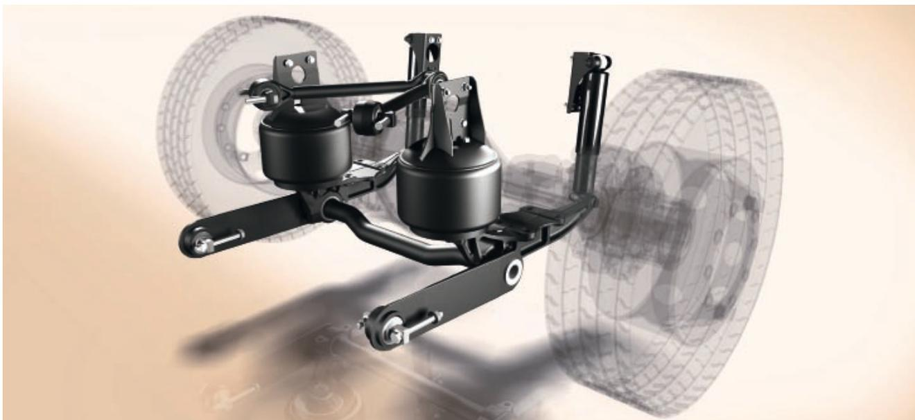
Пневматическая подвеска с 2 пневморессорами для седельных тягачей с колесной формулой 4 x 2 и 6 x 2 не требует установки задних упругих пневморессор, что позволяет разместить амортизаторы непосредственно позади моста. Это улучшает динамику движения и повышает устойчивость автомобиля при колебаниях в продольной плоскости.
