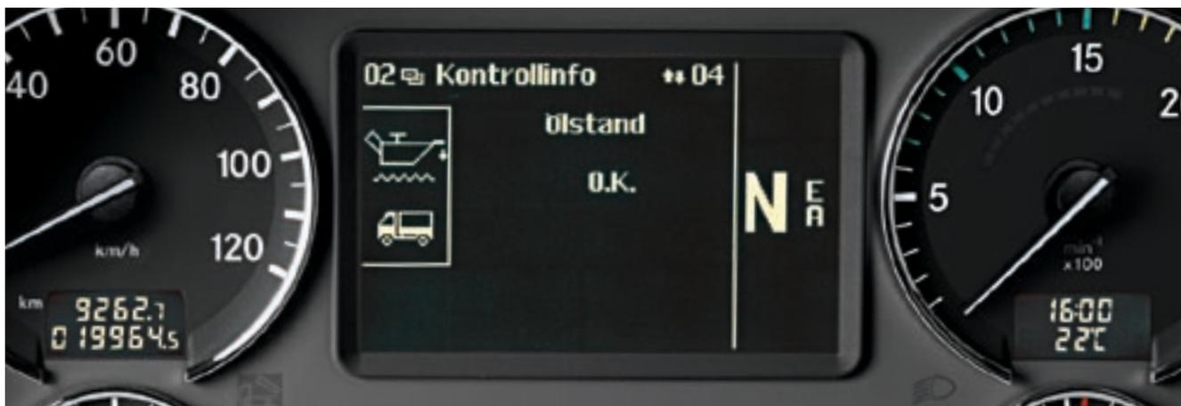
Система контроля технического обслуживания Telligent® увеличивает межсервисные интервалы Actros до 120 000 км, что повышает коэффициент готовности автотранспорта и снижает затраты. У Axor межсервисный интервал составляет 100 000 км, а с опционально доступной системой контроля технического обслуживания Telligent он увеличивается до 120 000 км.
