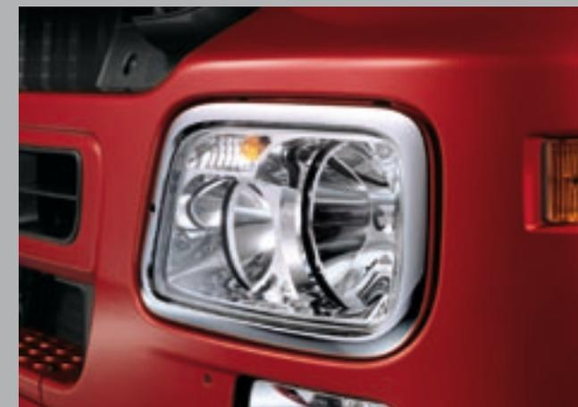
Быстрое переключение с ближнего света на дальний. Защитные стекла на фарах Actros можно в случае повреждений заменить отдельно.
