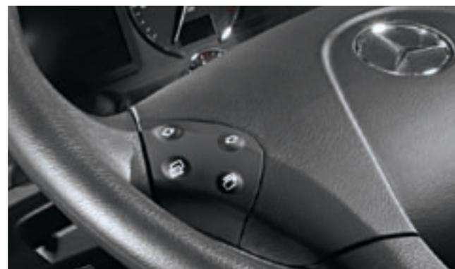
При помощи кнопок многофункционального руля водитель может управлять телефоном, магнитолой и информационной системой. Кроме того, водитель может пользоваться функциями диагностики и различными установками, начиная с будильника и заканчивая системой дополнительного обогрева.
