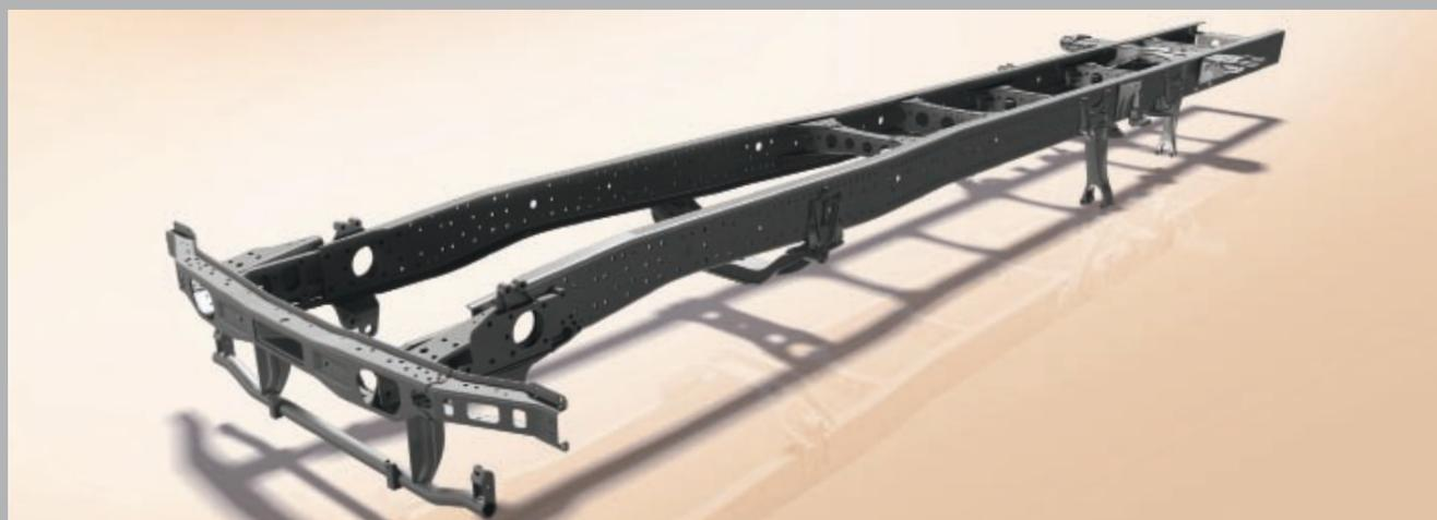
Объединяет в себе максимальную грузоподъемность с минимальной собственной массой для использования в сферах, для которых полезная нагрузка играет важную роль. В зависимости от модификации автомобиля и сферы толщина продольной балки на раме Ахог составляет 8,0 и 9,5 мм. Кроме того, 50-мм сетка с системой отверстий обеспечивает простейший монтаж, а катодное грунтование погружением – наилучшую коррозионную защиту.
