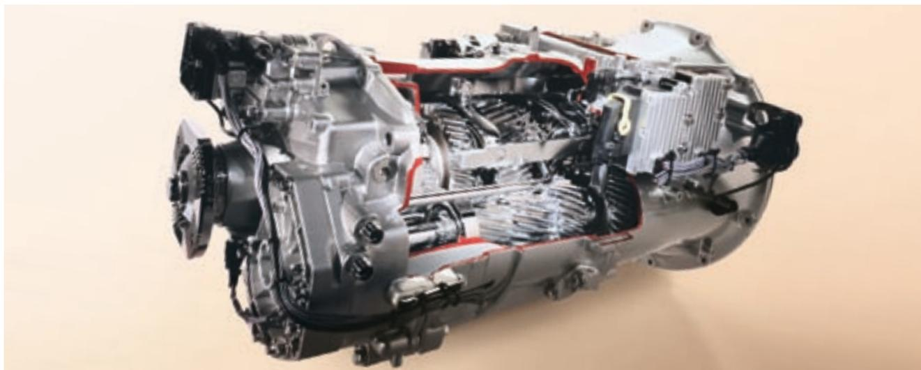
Новая, входящая в стандартную комплектацию Mercedes PowerShift 2, значительно добавляет динамики, обеспечивает оптимальное управление автомобилем и снижает расход топлива. Кроме всего прочего это достигается плавным переключением передач, применением оптимизированной стратегии переключения, которая использует датчики наклона, а также сокращенными интервалами силовых замыканий и уменьшенным раскачиванием автомобиля как в поперечной, так и в продольной плоскости.
