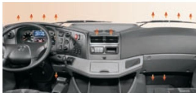
Ахор серийно оснащается эффективной системой вентиляции и отопления с устройством регулирования подачи воздуха и быстрого нагревания его до приятной температуры. Доступный по желанию заказчика кондиционер дополнительно повышает комфорт. Кроме того, опционально доступная бесшумная система дополнительного отопления теплым воздухом с двумя отверстиями для выхода воздуха обеспечивает оптимальное распределение воздуха.
