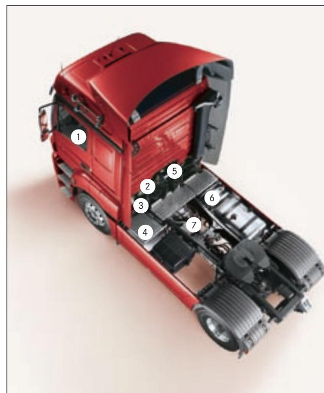
BlueTec® состоит из следующих компонентов: 1. Системная диагностика и индикатор системных сообщений на рабочем месте водителя. 2. Блок управления и дозирования. 3. Блок впрыска жидкости AdBlue. 4. Глушители из высококачественной стали со встроенным катализатором SCR. 5. Усовершенствованный двигатель. 6. Бак жидкости AdBlue. 7. Блок управления.
