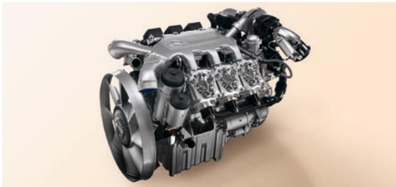
Основа BlueTec® – двигатели с особо чистым процессом сгорания с малым выбросом твердых частиц. В поток отработавших газов при их выходе из двигателя производится впрыск AdBlue, который при помощи SCR-катализатора преобразует угарные газы в безобидные компоненты – азот и воду.
