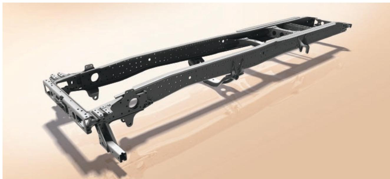
Рама Actros, оптимизированная по массе, имеет благодаря катодному нанесению лакокрасочного покрытия погружением и 50-мм перфорированной решетке особо прочную конструкцию и простую схему монтажа. Дальнейшие преимущества: передняя часть рамы, все детали которой скреплены болтами, благодаря чему процесс их замены не доставляет никаких трудностей; расположение фар вверх участков переднего обтекателя, особо опасных из-за попадания в них камней.
