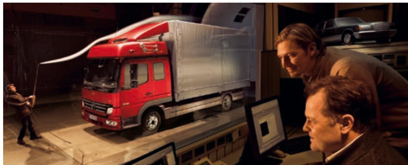
Экономически обоснованная оптимизация: идеально сбалансированная аэродинамика является решающим фактором не только в снижении расхода топлива, но и, к примеру, в уменьшении возникающих вследствие действия сопротивления ветра шумов, создаваемых транспортным средством при движении, а также бокового загрязнения дверей и окон.
