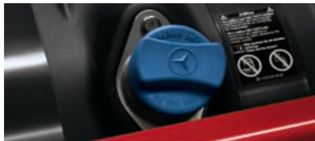
На 25 литров используемого дизельного топлива приходится приблизительно 1 л AdBlue. Серийно устанавливаемый бак для AdBlue на седельных тягачах имеет объем 85 л; этого будет вполне достаточно на 6500 км, или для поездки из Гамбурга до Афин и обратно. AdBlue доступен на всей территории Европейского союза, но также и за его пределами: [www.findadblue.de](http://www.findadblue.de)
