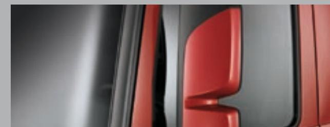
Новые наружные зеркала с низким уровнем вибрации обеспечивают оптимальную защиту зеркал и боковых частей от загрязнения. В качестве опции доступна покраска корпуса зеркала в цвет автомобиля, двухслойное хромирование или рифление<sup>1)</sup>.
