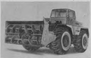
Рис. 10. Шнекороторный снегоочиститель ДЗ-207 (Д-601С) на шасси тягача МоАЗ-542.
