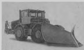
Рис. 8. Двухотвалный плужный снегоочиститель ДЗ-214 на тракторе К-700А
