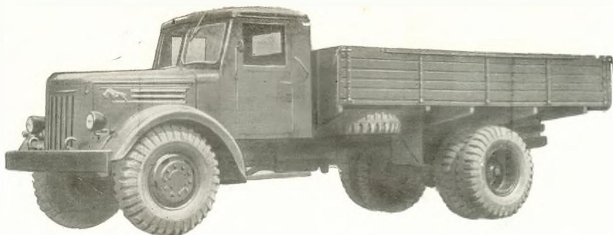
Грузовой автомобиль предназначен для междугородных перевозок грузов на дорогах 1 и 2 классов. Автомобиль оборудован выводами тормозной и электрической систем прицепов. Рекомендуемый прицеп — МАЗ-5243.
