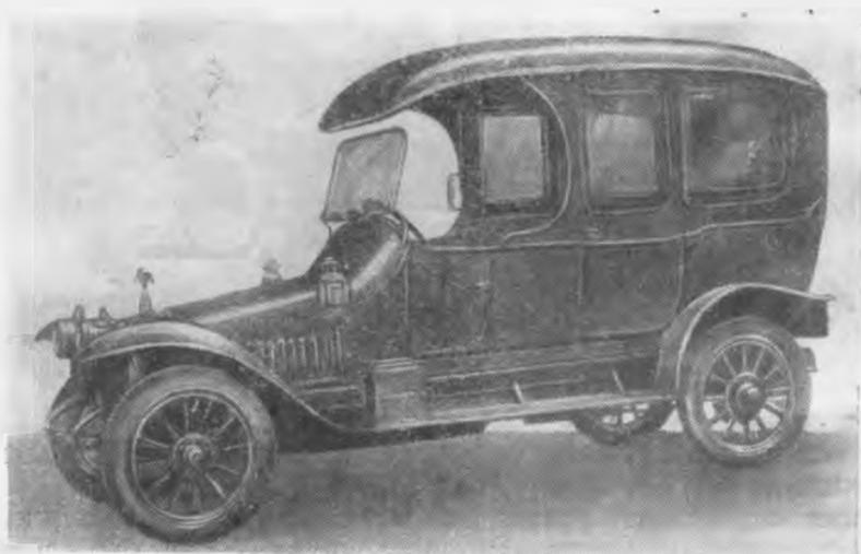
Рис. 10. Автомобиль «Руссо-Балт» с кузовом типа ландоле
