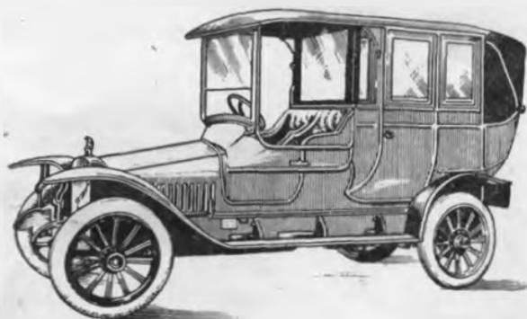
Рис. 8. Автомобиль «Руссо-Балт» с кузовом типа лимузин
