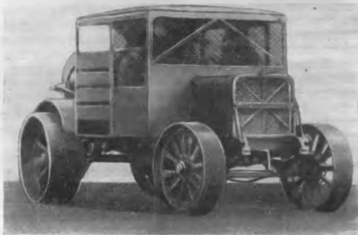
Рис. 18 Специальный 5-тонный тягач «Руссо-Балт» для буксировки мишеней
