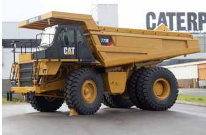
>>> Карьерный самосвал 773E грузоподъемностью 55,5 т, выпускаемый на заводе Caterpillar в Тосно
