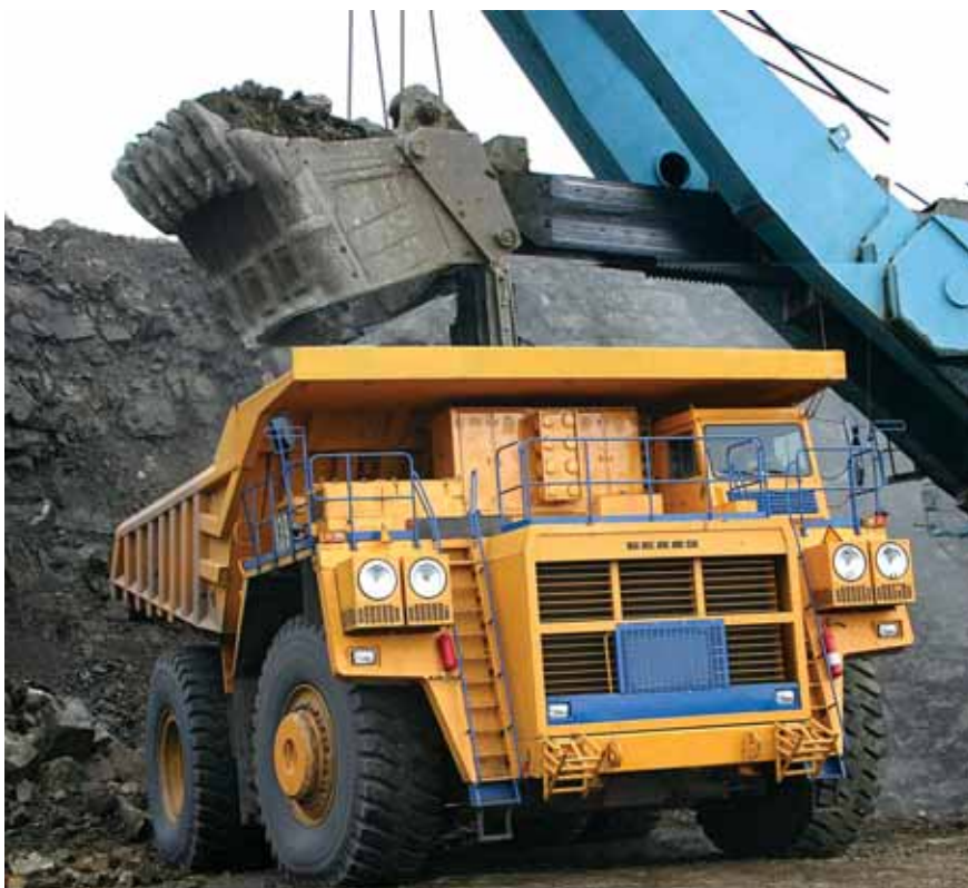
Карьерный самосвал БелАЗ-75306 грузоподъемностью 220 т
