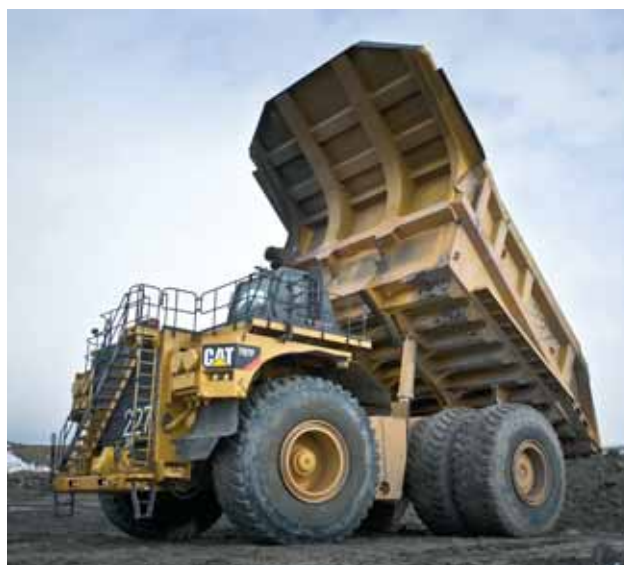
>>> Карьерный самосвал Caterpillar 797F грузоподъемностью 350 т
