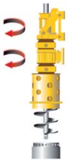
Бурение штангой келли с осадными трубами (установка обсадных труб при помощи BTM) Cased Kelly Drilling (Casing Installation with BTM)
