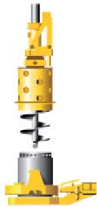
Бурение штангой келли с осадными трубами (установка обсадных труб при помощи BV) Cased Kelly Drilling (Casing Installation with Oscillator)
