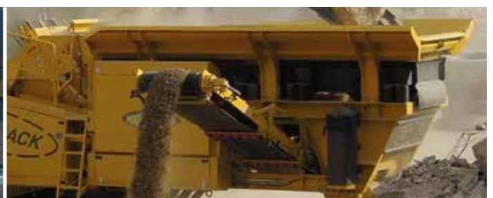
Предварительный грохот с отдельным приводом
