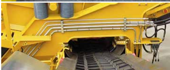
Стальные гидравлические линии
