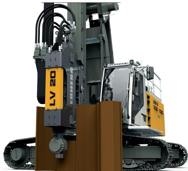
Погружение промежуточной секции шпунта
