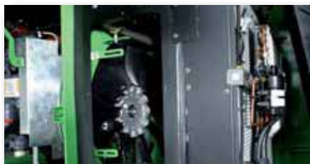
Отсек радиатора с 3-х контурной системой охлаждения для нагнетания воздуха, охлаждения воды и масла The cool box with 3-circuit cooling system for charge air, water and oil cooling
