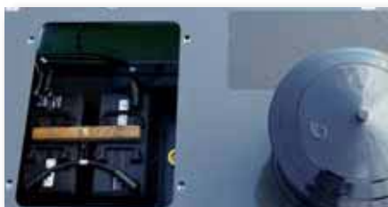
Прекрасный доступ к аккумуляторам и воздушному фильтру Excellent access to the batteries and air filter
