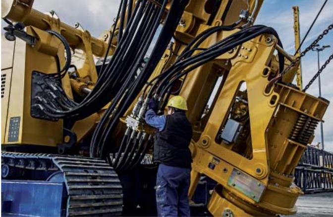
Aufbaustellung zum Anschluss der Hydraulikschläuche
