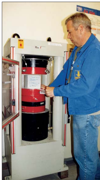
Messung der Druckfestigkeit am Betonwürfel
