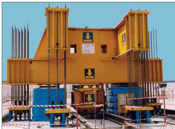
Pfahltest für den von Bauer International Abu Dhabi gegründeten Burj Dubai
