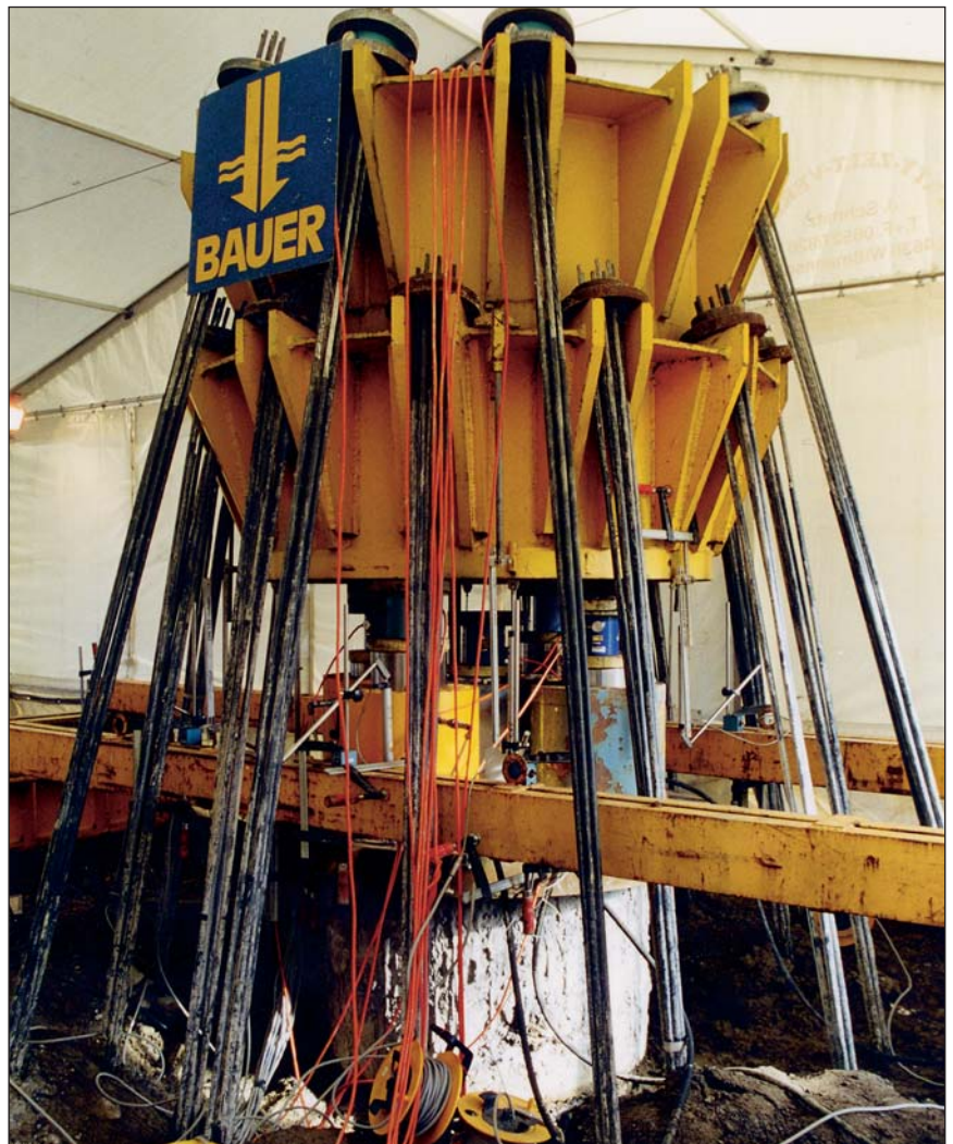
Pfahltest in Zelteinhausung bei Daun in der Eifel
