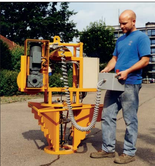
Mit dem bei Bauer entwickelten und gebauten Seilneigungsmessgerät wird die Vertikalität von Bohrungen kontrolliert.
