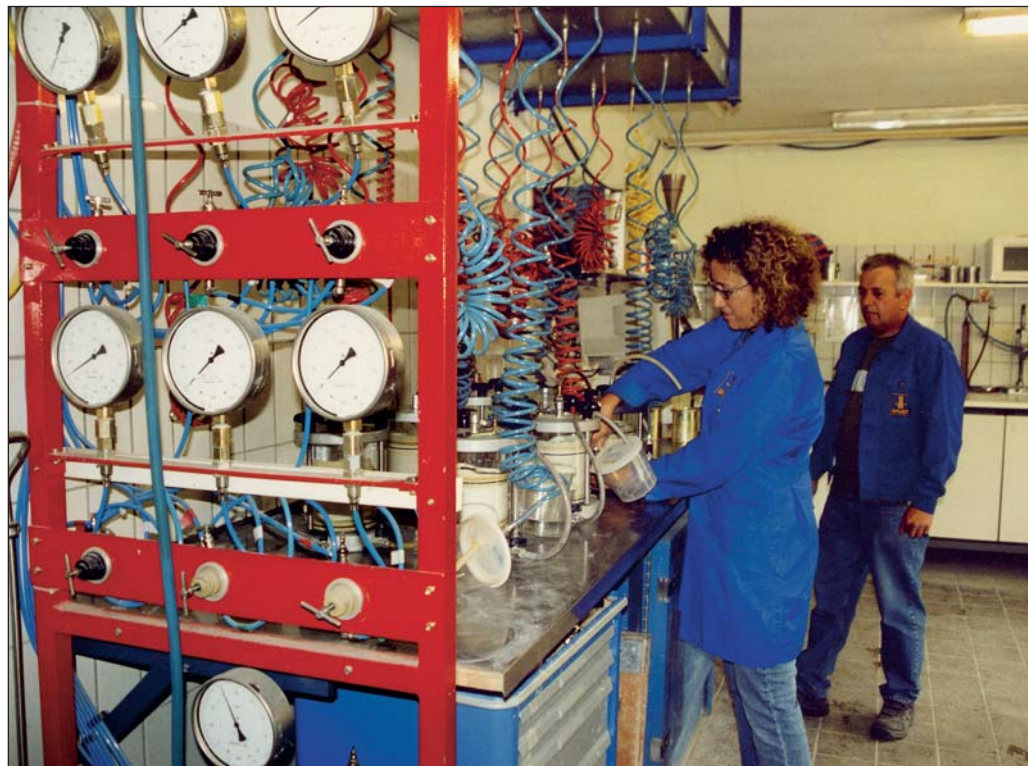
Labor der Abteilung Bautechnik: Wasserdurchlässigkeitsversuch an Beton. Auch auf großen Baustellen unterhält Bauer Spezialtiefbau eigene Baustellenlabors, um die Qualität der angelieferten Baustoffe, z. B. Beton und Suspensionen, laufend zu prüfen.
