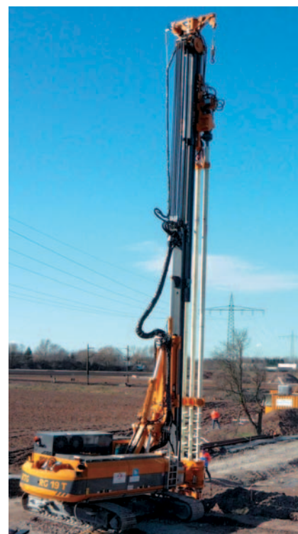
Оборудование SMW с тройным приводом на RG 19T SMW-attachment with triple drive on RG 16T, (Germany)
