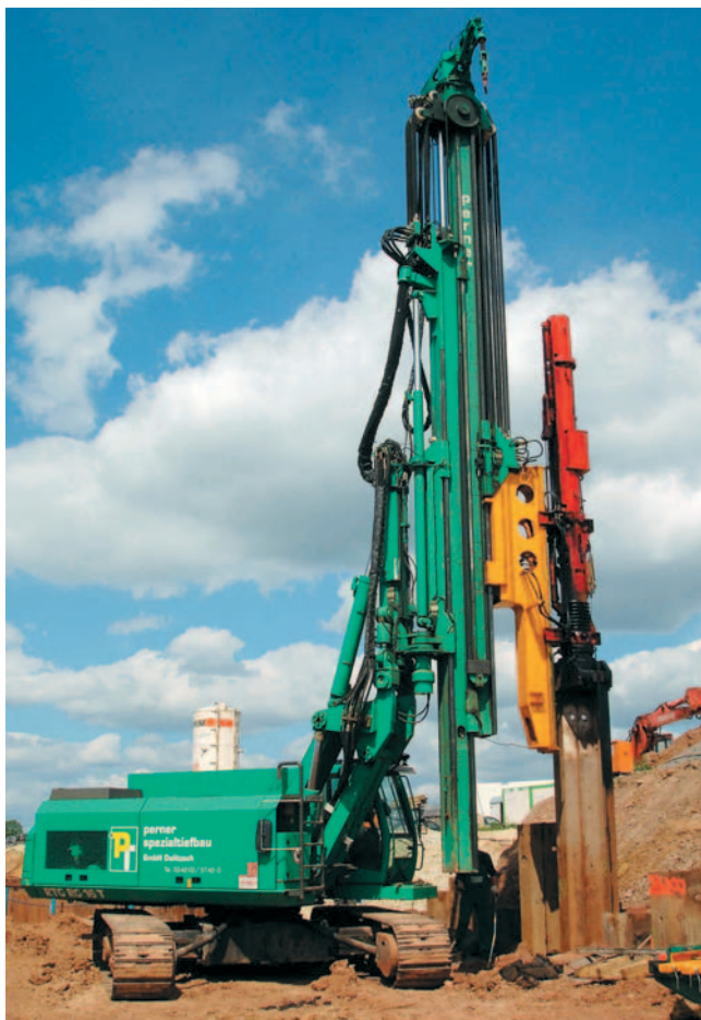
RG 16 T с дизельным молотом для создания шпунтовых стен RG 16 T with Diesel hammer for driving sheet piles (Germany)
