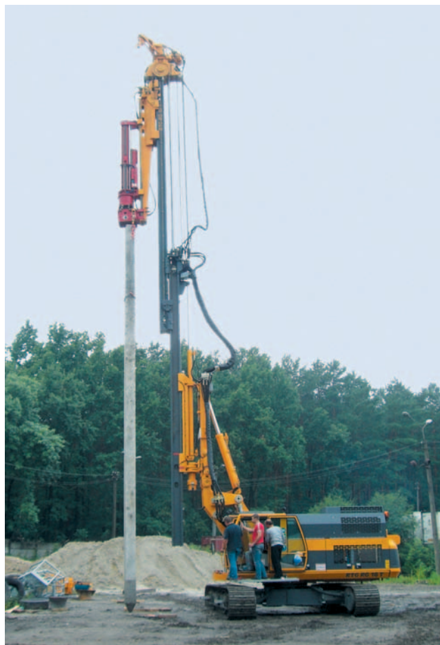
RG 16 T с гидравлическим молотом FAMBO RG 16 T with FAMBO hydraulic hammer (Ukraine)
