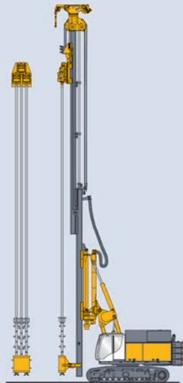
SMW Bodenmischen mit Dreifachpaddel Soil Mixing Wall System
