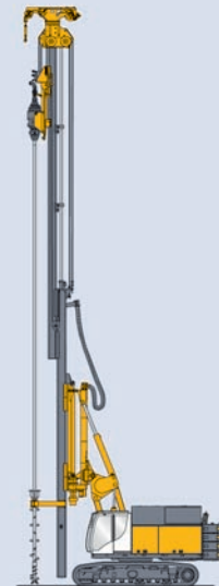
SCM Bodenmischen mit Einfachpaddel Single Column Mixing
