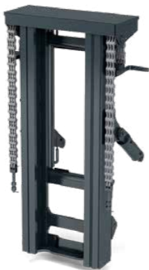
Сдвоенные, 2-ступенчатые, без упора в переднюю ось
