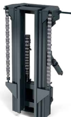
Строенные, 3-ступенчатые, с упором в переднюю ось
