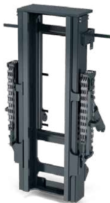
Сдвоенные, 2-ступенчатые, с упором в переднюю ось
