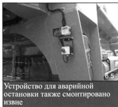
Аварийный режим работы функционирует отдельно от электронной системы
