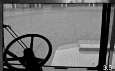
Неограниченный обзор благодаря наклонной поверхности капота
