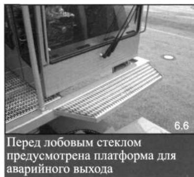
Аварийный выход предусмотрен через лобовое стекло
