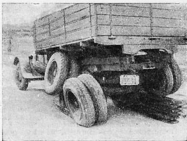
Грузовик ЗИС-6 с предельным переносом задних осей
