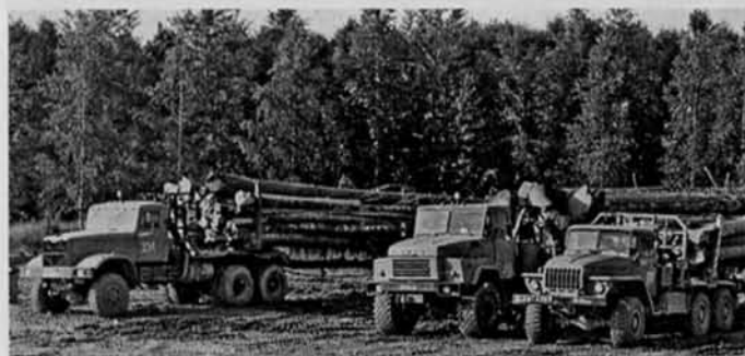
Соперниками двускатных КрАЗов (на фото слева – «6439-й») были новый «лаптежник» КрАЗ-260ЛС с роспуском ГKB-93852 (в центре), «Урал-4320» с ГKB-9851 (справа) и МАЗ-5434 с ГKB-9362. 1982 г.
