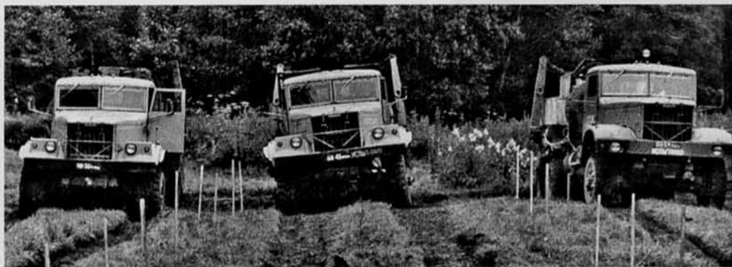
Испытания трёх лесовозов на колееобразование. Слева – направо: стандартный «лаптежник» КрАЗ-255Л, двускатный КрАЗ-255Л на шинах 370-508 и двускатный КрАЗ-6439 на шинах 320-508 (12,00-20)
