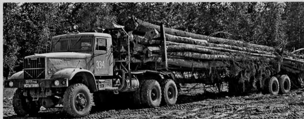
В 1981–1982 гг. на Урале проходил испытания КрАЗ-6439 – модернизированный лесовоз на основе 6506 с шинами ИЯВ-12Б размерности 12,00-20, работавший в паре с роспуском ГКБ-9383 производства Тавдинского механического завода
