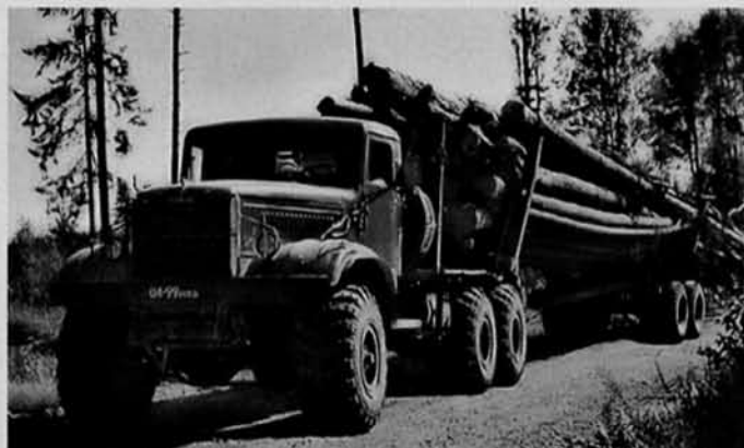
С 1969 г. мелкосерийно начали выпускать «лаптёжник» КраЗ-255Л с односкатными широкопрофильными шинами 1300х530-533. На фото экземпляр из Новгородской области
