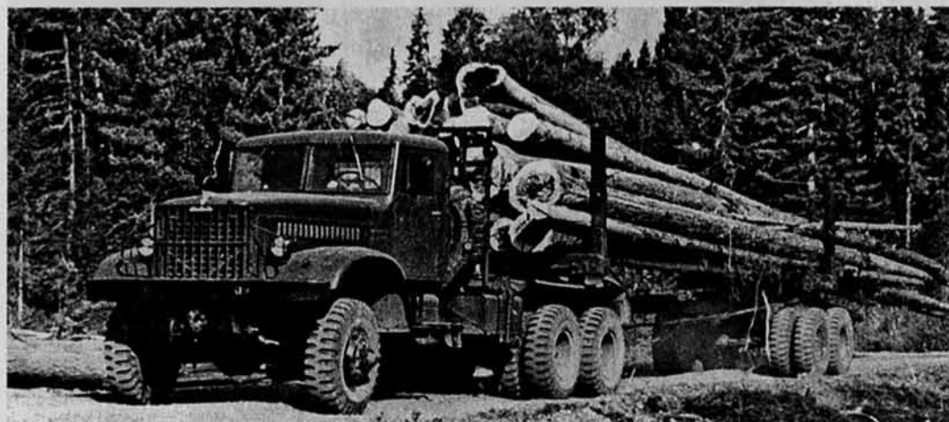
Опытно-промышленный лесовоз КрАЗ-214ЛК2 с двускатными дисковыми колесами и шинами модели И-78 размера 12,00-20 в паре с роспуском 2-Р-15. 1964 г.
