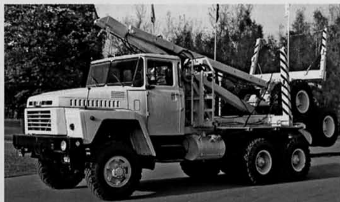
По итогам успешных испытаний, в том числе и переходного 6439, новый лесовоз КрАЗ-6437 с кабиной и оперением типа КрАЗ-250 и двускатной ошиновкой 320-508 получил путёвку в жизнь. Москва, ВДНХ, 1984 г.
