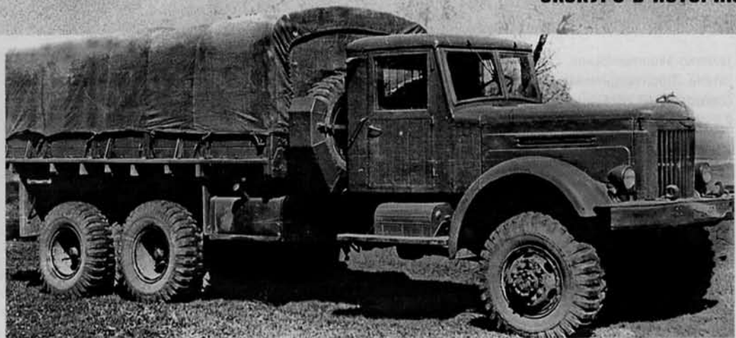
Самый ранний опытный образец ЯАЗ-214 (6х6) имел стандартные колеса типа «ЯАЗ» под 10 шпилек и шины 12,00-20 дюймов. 1951 г.
