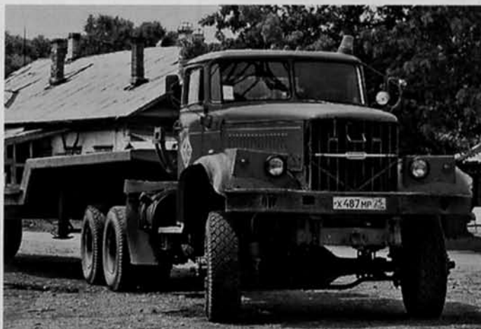
Кроме шин 12,00-20 этот образец имел и цельнометаллическую кабину от «Урал-375». Усурийск, 2006 г.
