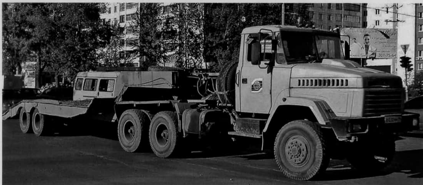
С приходом рыночных отношений спрос на двускатные полноприводные КраЗы не упал, а скорее наоборот. Ныне в такой комплектации (уже вновь с дисковыми колесами) производят бортовые грузовики, лесовозы, сортиментовозы, тяжёлые транспортировщики и др. И конечно же 330-сильные «седельники» КраЗ-6443 (на фото), способные тянуть полуприцепы массой до 65 т
