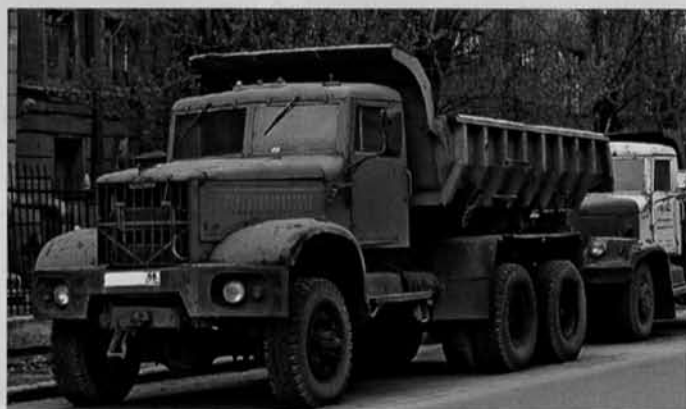
Имели место и аналогичные двускатные самосвалы, по сути являвшие собой гибридную версию моделей 255Б1 и 256Б1. Санкт-Петербург, 2008 г.
