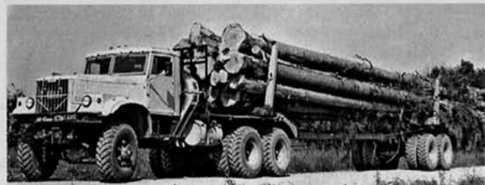
Экспериментальный автопоезд на базе КрАЗ-255Л с двускатными шинами 370-508 низкого давления модели Я-307 в паре с роспуском ЛТ-56 на таких же шинах показал тогда еще более высокие результаты. 1982 г.
