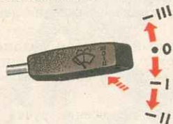
Рис. 3.3. Положения рычага переключателя стеклоочистителя и стеклоомывателя
