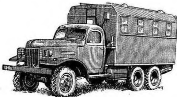
Рис. 334. Унифицированный кузов типа СН на шасси автомобиля ЗИЛ-151
