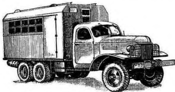
Рис. 335. Войсковая автомобильная ремонтно-эксплуатационная мастерская ВАРЭМ-3 в походном положении
