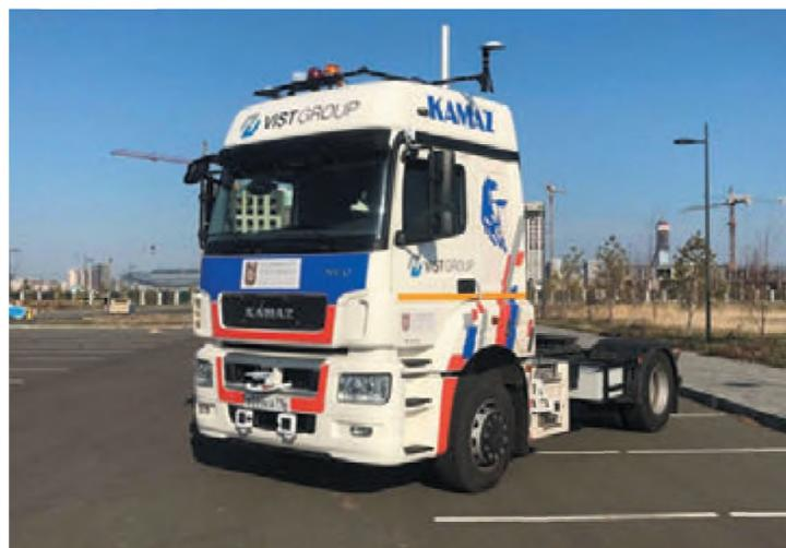
*Новейший роботизированный автомобиль на базе тягача КАМАЗ-5490 NEO*
