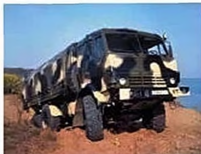
За счет применения межколесных сплюснутых дифференциалов и новых широкопрофильных шин проходимость Мустангов значительно улучшилась
