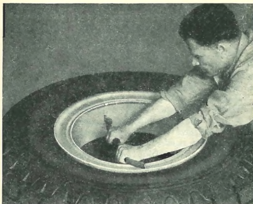
Obr. 138. Uzavření ráfku se provádí ohnutou pákou, kterou lze v případě potřeby (např. při montáži nové obruče) prodloužit rovnou pákou neb trubkou vhodného průměru
