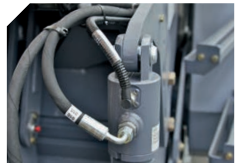
Wegmesssensoren im Hydraulikzylinder messen die Frästiefe exakt ▼
