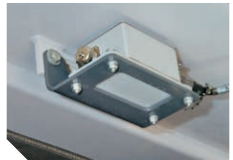
Elektronischer Querneigungs- sensor „Rapid Slope“ für das Fräsen vorgegebener Querneigungen ▲
