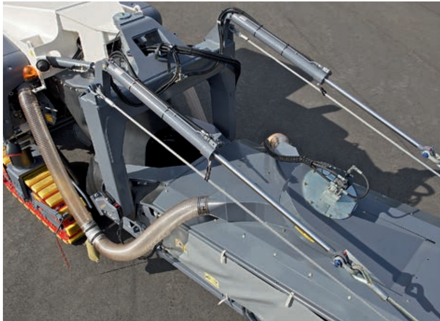
Die Drehzahl des Radiallüfters ist verstellbar.
