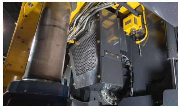
Хорошо выполнены система хода и подъемные колонны. Большой диаметр колонн обеспечивает меньшее напряжение на единицу поверхности и тем самым более длительный срок службы направляющих.
