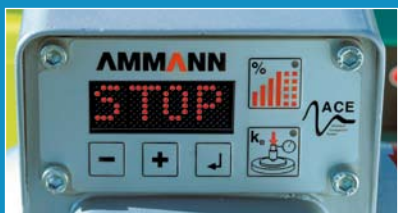
Режим Гидравлический останов (Аварийный останов)
