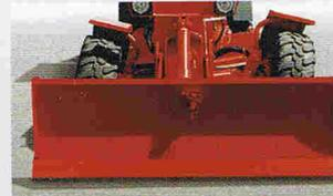
Die Radsturzerstellung ermöglicht ein sauberes und sicheres Arbeiten an der Böschung, kein Schubkraftverlust durch häufiges Gegenlenken.
