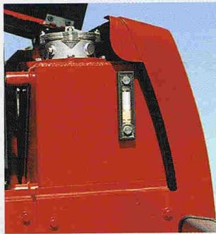
Lange Wartungsintervalle, z.B. beim voll gekapselten Drehkranz oder durch die spielfreie Lagerung des Rollendrehkranzes, die Nachstarbeiten gänzlich überflüssig machen, sparen Wartungszeit. Hinzu kommt die gute Zugänglichkeit zu allen Inspektions- und Wartungspunkten, die den Zeitaufwand deutlich reduziert und die Produktivität steigert.
