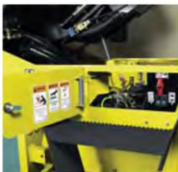
Наклоняемая кабина для безопасного и легкого обслуживания и ремонта
