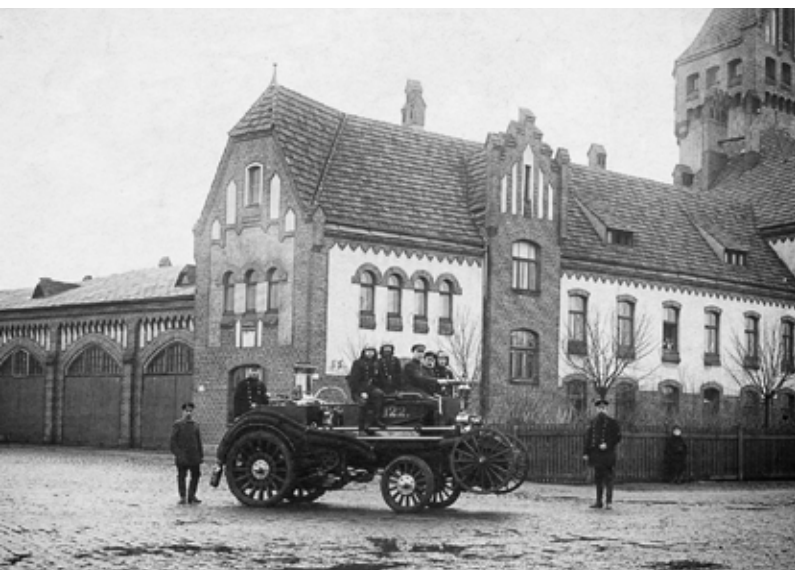
■ Самоходная паровая «пожарная труба» Merryweather «Fire King» Self-Propelled Steam Fire Engine Рижской городской пожарной команды, 1910 г.
