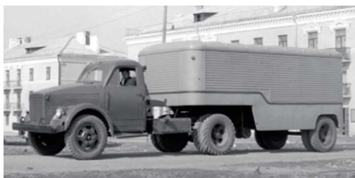
ГАЗ-51П и протомтарный полуприцеп ПА3-744. На заднем мосту тягача внедорожная резина
