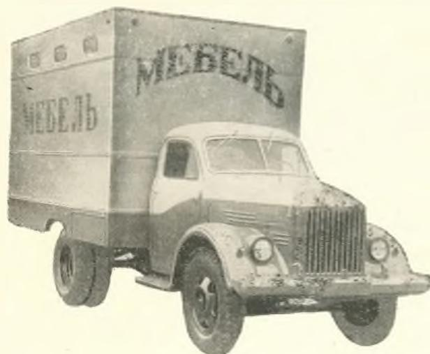
Автомобиль-фургон ГЗТМ-954 на шасси автомобиля ГАЗ-51А с удлиненной рамой предназначен для перевозки и доставки населению мебели.
