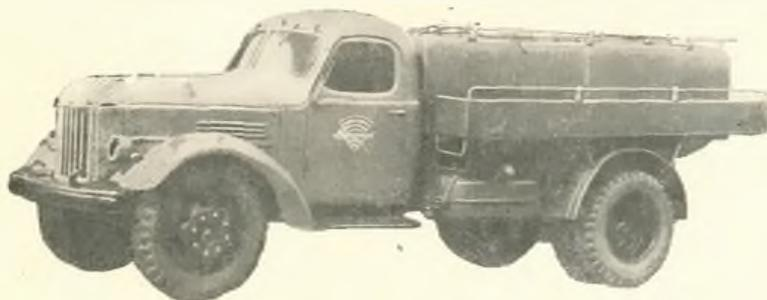
Автомобиль-цистерна АЦПТ-2,8 на шасси автомобиля ЗИЛ-164А предназначен для перевозки живой рыбы от промысла до торговых точек, а также при переселении ее из одних водоемов в другие.
