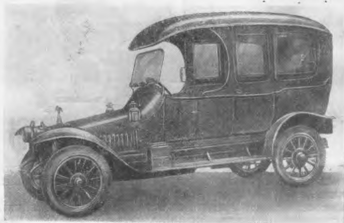
Рис. 10. Автомобиль «Руссо-Балт» с кузовом типа ландоле
