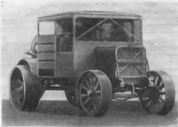
Рис. 18. Специальный 5-тонный тягач «Руссо-Балт» для буксировки мишеней
