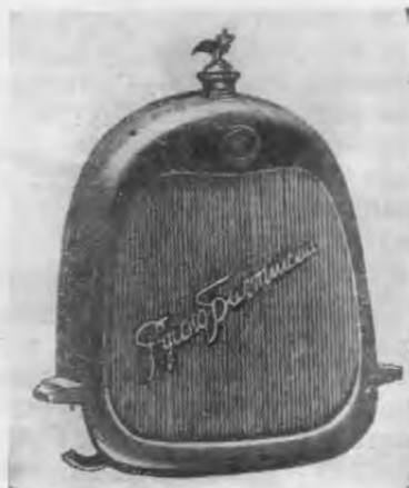
Рис. 12. Радиатор автомобилей «Руссо-Балт» выпуска 1915 г.
