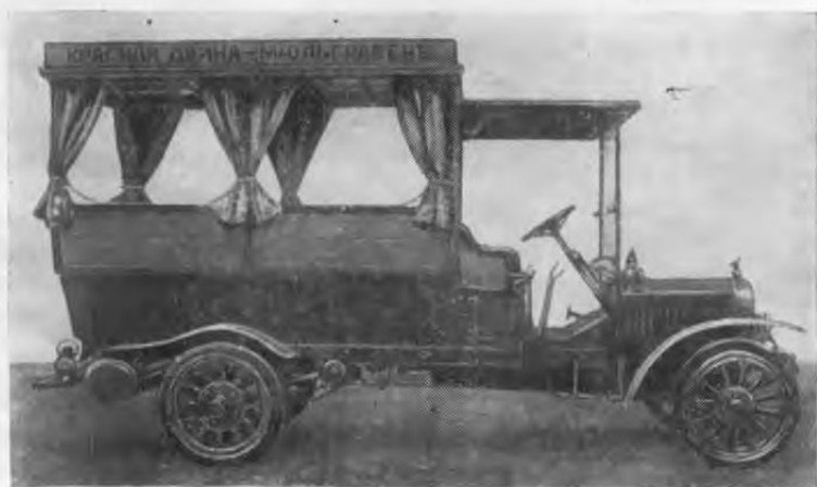
Рис. 15. Омнибус «Руссо-Балт» на шасси грузового автомобиля модели М (1913 г.)
