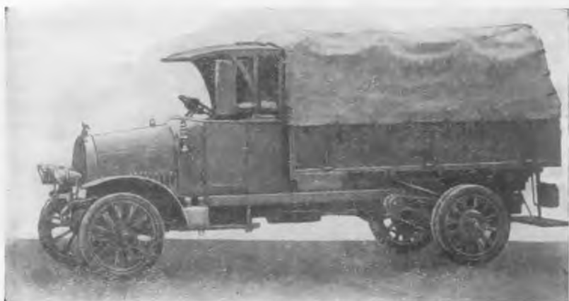
Рис. 16. Грузовой автомобиль «Руссо-Балт» модели М выпуска 1914 г.
