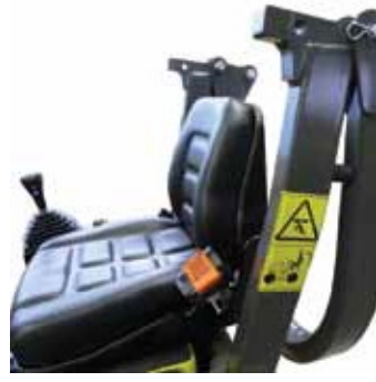
Складной ROPS для легкой транспортировки
