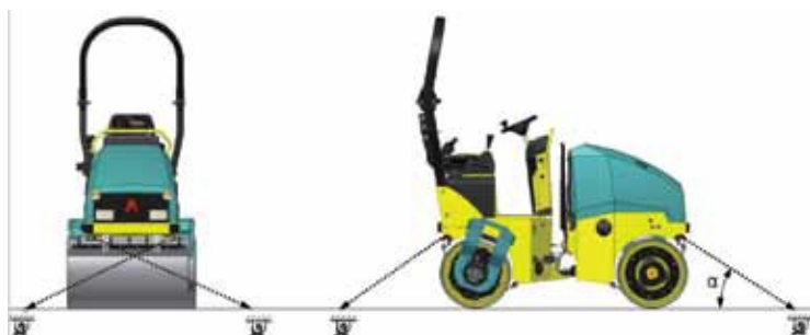
4 проушины для безопасного крепления на прицепе /грузовике
