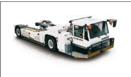
AST-2: Mittlerer Flugzeugschlepper für Flugzeuggewichte bis zu 300 t MTOW für Flugzeug-Baumuster von Fokker 70 bis zu A340-300 / B777-300
