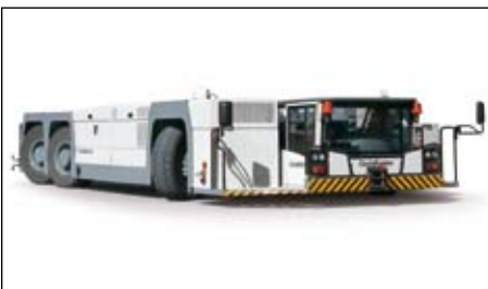
AST-1 X (6x6): Größter Flugzeugschlepper für Flugzeuggewichte bis zu 600 t MTOW für Flugzeug-Baumuster von B767 bis B747-8 und A380
