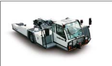
AST-3: Kleiner Flugzeugschlepper für Flugzeuggewichte bis zu 220 t MTOW (AST-3F) bzw. bis zu 160 t MTOW (AST-3L) für Flugzeug-Baumuster von ERJ 135/145 bis B767-400
