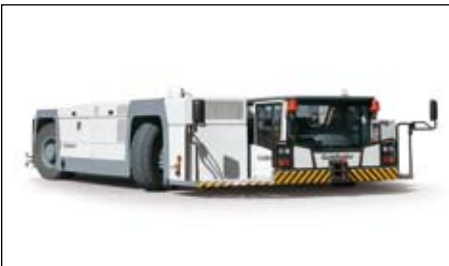
AST-1: Großer Flugzeugschlepper für Flugzeuggewichte bis zu 425 t MTOW (AST-1F/L) für Flugzeug-Baumuster von A300/B767 bis B747 bzw. bis zu 600 t MTOW (AST-1X) für Flugzeug-Baumuster von B767 bis B747-8 und A380
