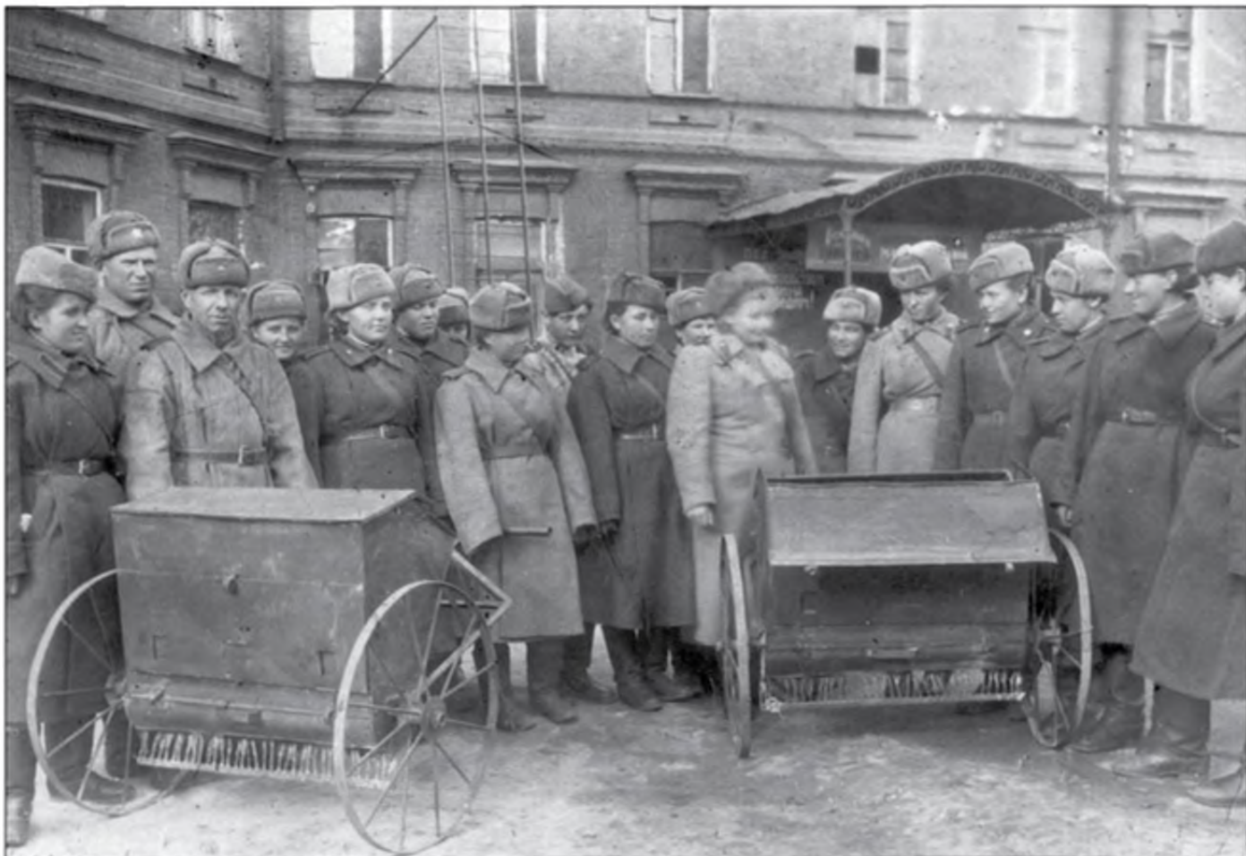
Возимые дегазационные приборы ВДП
