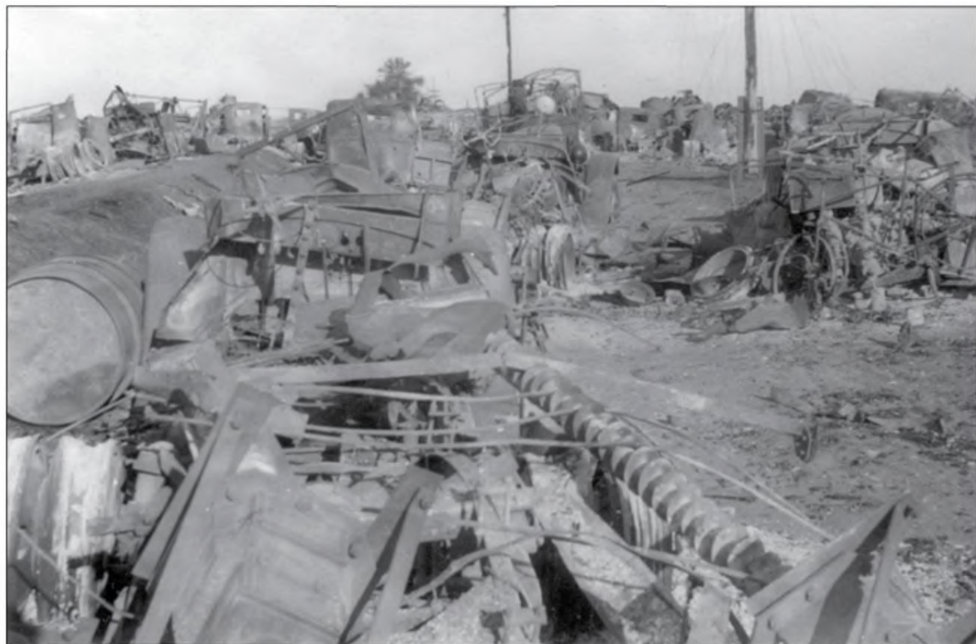
Уничтоженные в первые дни войны автодегазаторы хлорной известью. Хорошо виден шнековый механизм для подачи извести
