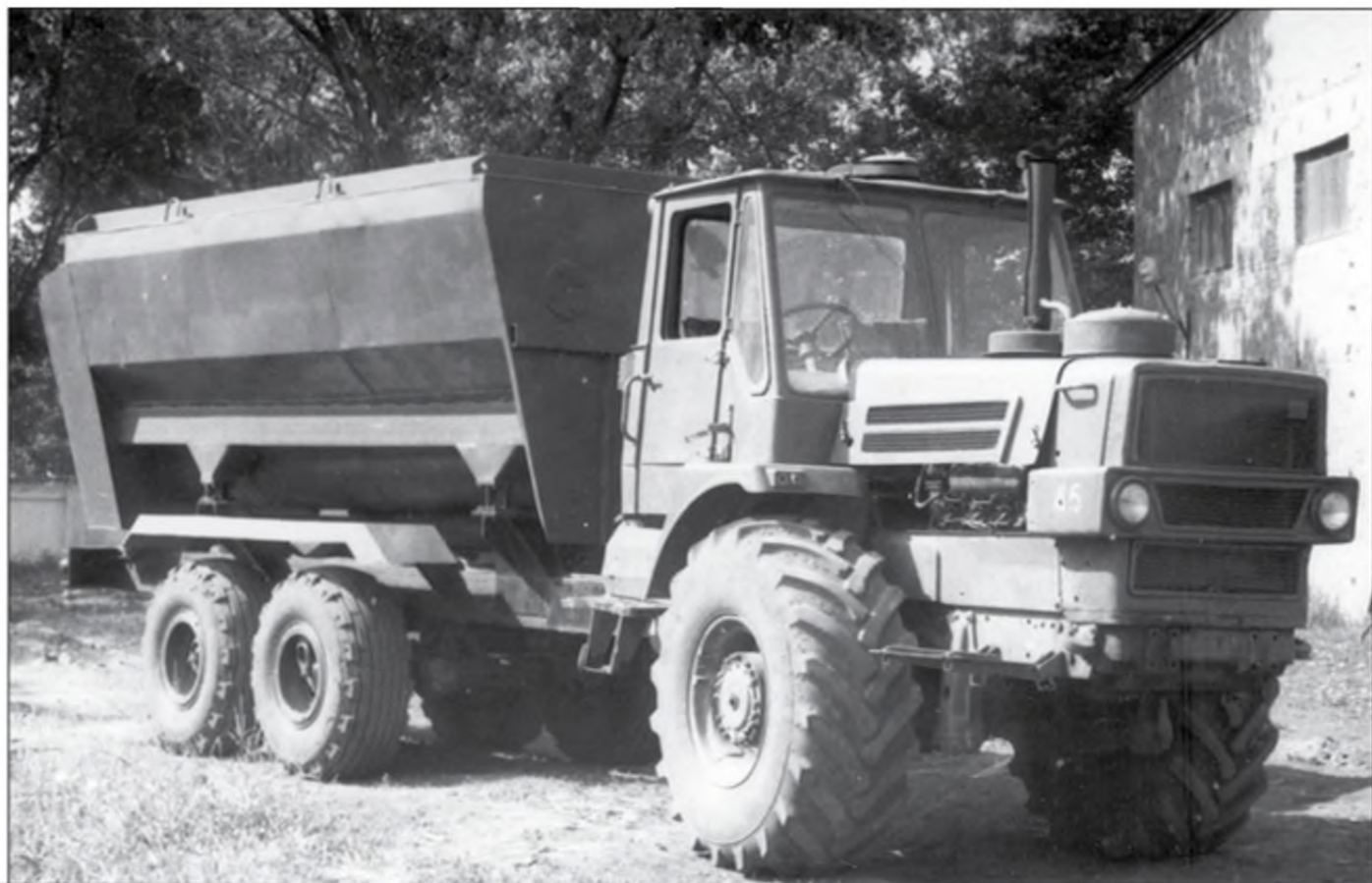
Мобильный кормораздатчик был изготовлен в июле 1979 г. по проекту ВНИПТИМЭСХ на базе трактора Т-150К и после проведения испытаний передан комплексу «Веселовский» в Ростовской области
