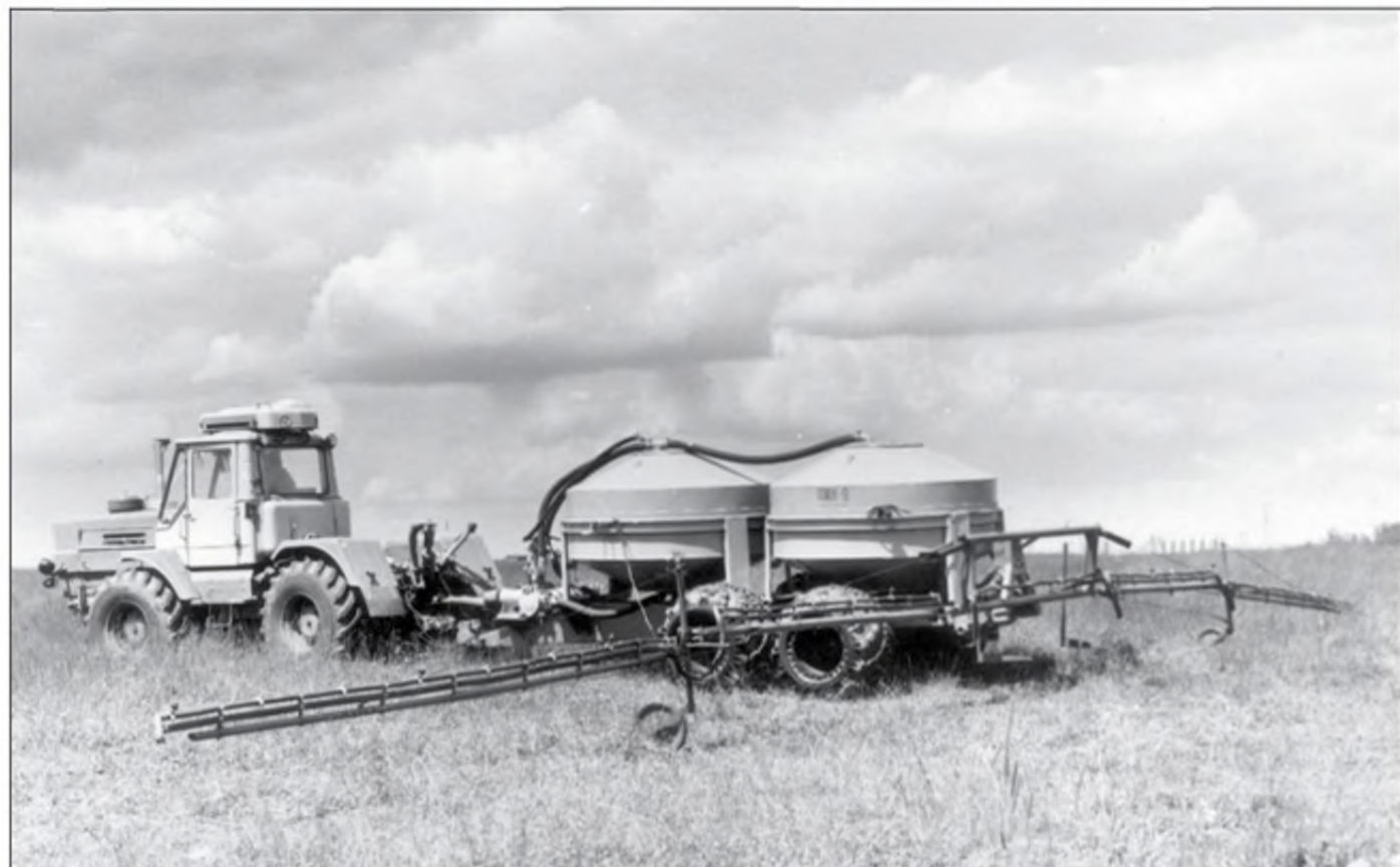
Прицепной жижеразбрасыватель ПЖУ-9 мог использоваться для обработки местности жидкими дегазаторами
