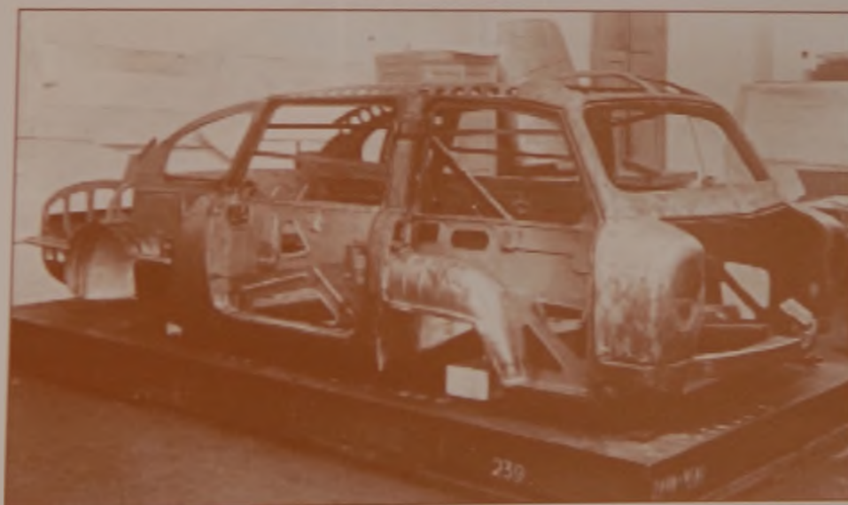
Экспериментальный легковой автомобиль с задним расположением двигателя НАМИ-013. Этапы создания кузова. Фото. 1951 г. Филиал РГАНТД. Ф. Р-351. Оп. 2-1. Д. 3628. Л. 47, 58, 59
