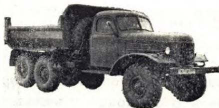
Автомобиль-самосвал 4510 на шасси ЗИЛ-157КД, прошедших капитальный ремонт, предназначен для перевозки насыпных и навалочных грузов.
