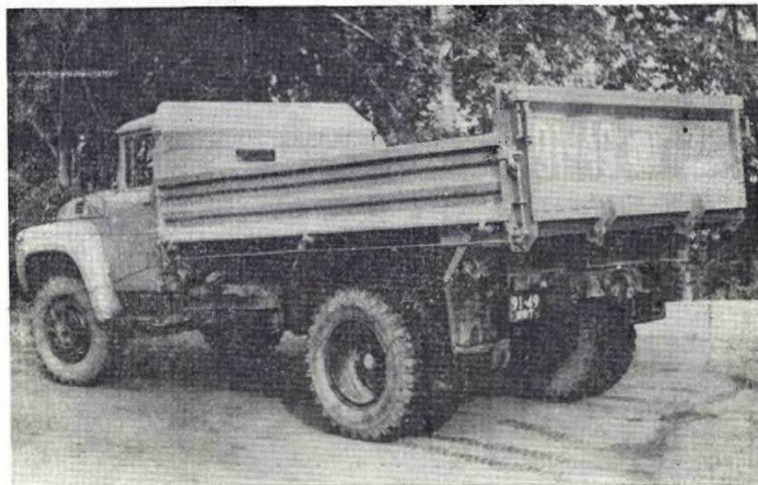
Строительный с трехсторонней разгрузкой платформы, рассчитанный для работы с прицепом.
