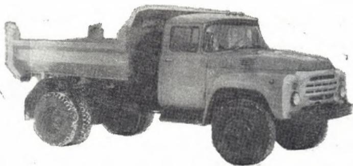
Автомобиль-самосвал 4505 на шасси ЗИЛ-495710 предназначен для перевозки насыпных и навалочных грузов.
