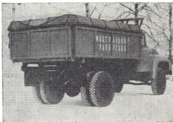
Предназначен для перевозки незатаренных минеральных удобрений. Платформа стальная, разгружается на три стороны; имеет укрытие в виде сдвигающегося на кольцах брезента.
