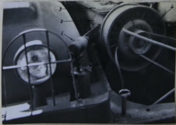
Рис. 35. Подогрев цилиндров двигателя Татра 111-А лампой обогрева. Вид справа сверху.
