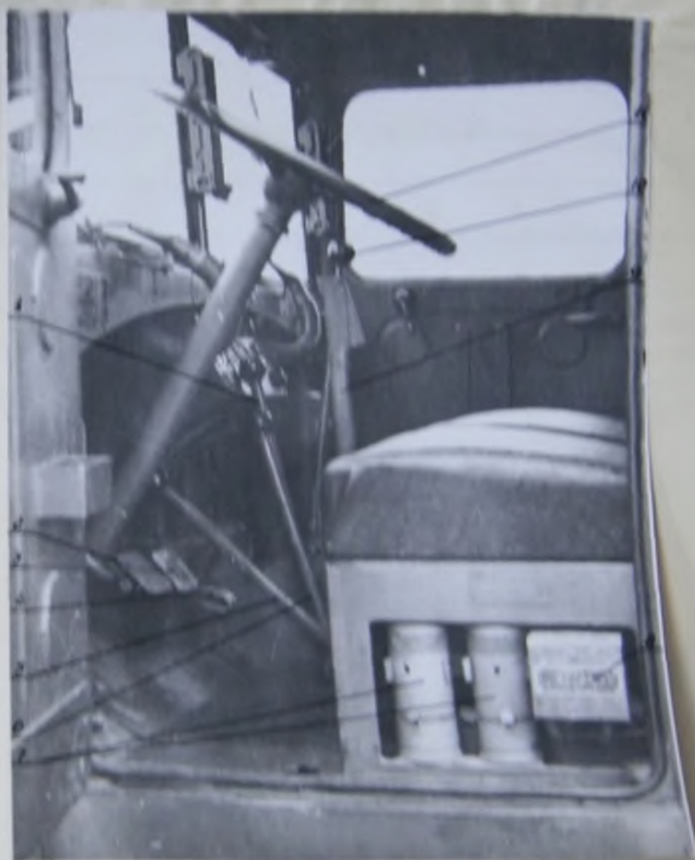
Рис. 30. Органы управления автомобилем.
