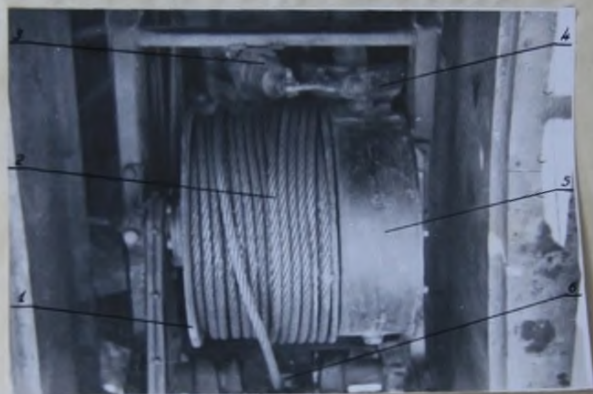
Рис. 32. Лебедка автомобиля Татра 111-Р
