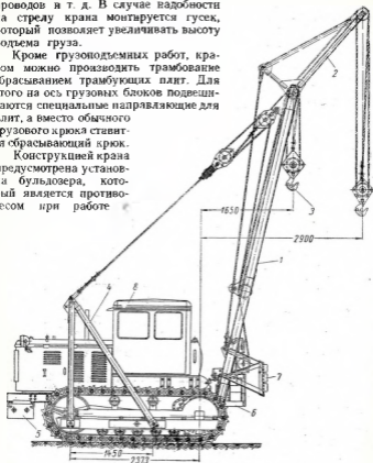
Фиг. 336. Тракторный кран 3-т навесной Т-92:
