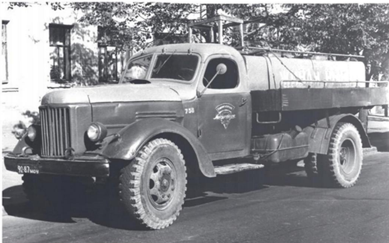
Самыми ранними автомобилями для транспортировки живой рыбы стали автоцистерны АЦЖР-3 на шасси ЗИЛ-164, выпускавшиеся Прилуцким заводом ППО с 1960 по 1970 гг.
