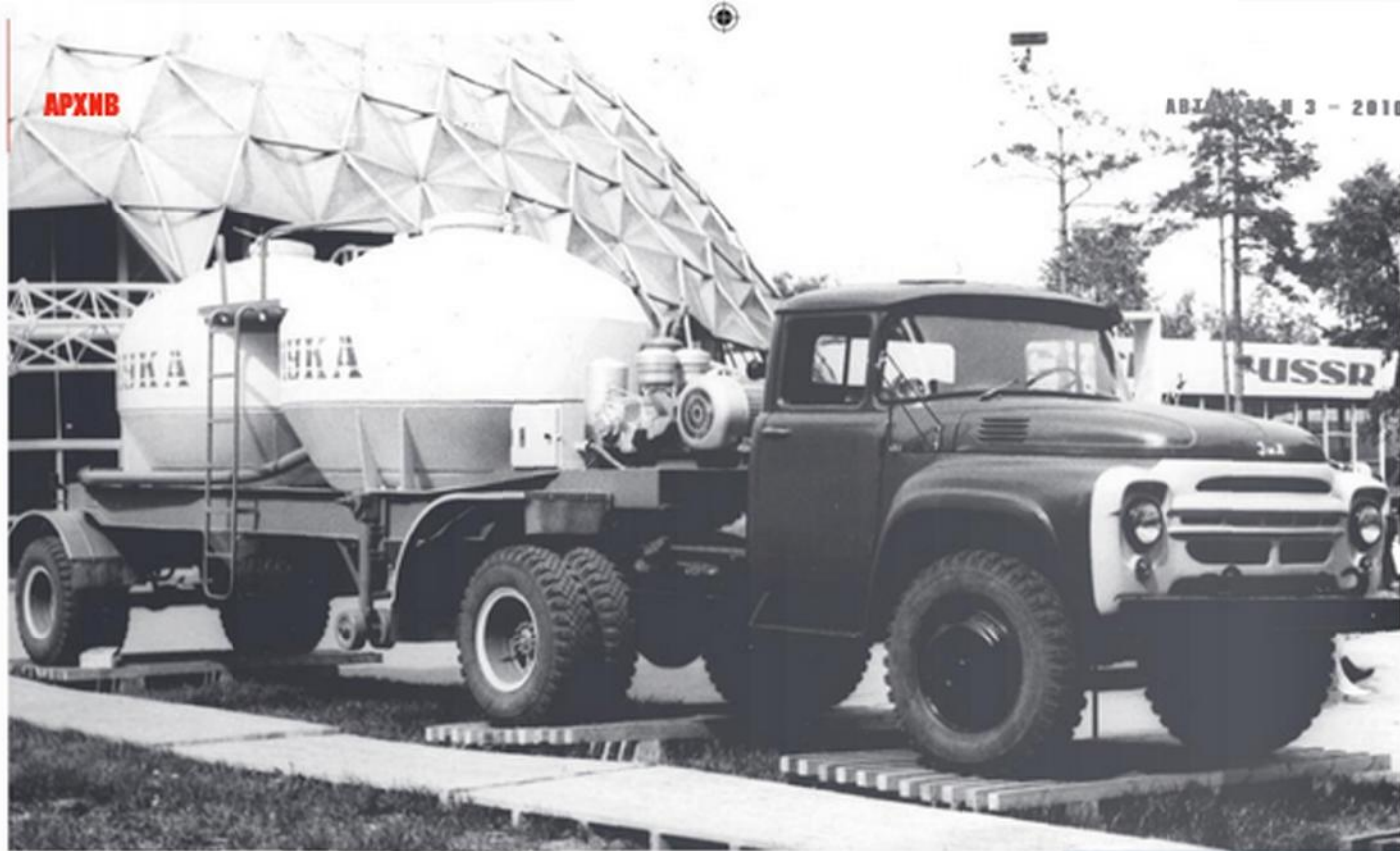
Седелный тягач ЗИЛ-130В с полуприцепом К-1040-Э для бестарной перевозки муки выпускался с 1961 по 1977 гг. «Одесским заводом Продмаш»
