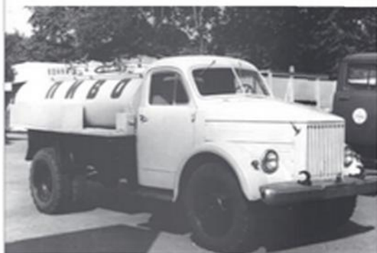
Пивозаправочная станция на шасси ГАЗ-51А, представленная «Главмосавтотрансом» на Выставке специализированных автомобилей, проводившейся на ВДНХ летом 1971 г.
