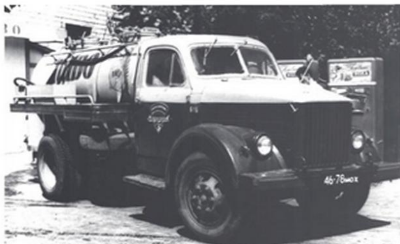
Пивозаправочная станция на шасси ГАЗ-51А, представленная «Главмосавтотрансом» на Выставке специализированных автомобилей, проводившейся на ВДНХ летом 1971 г.
