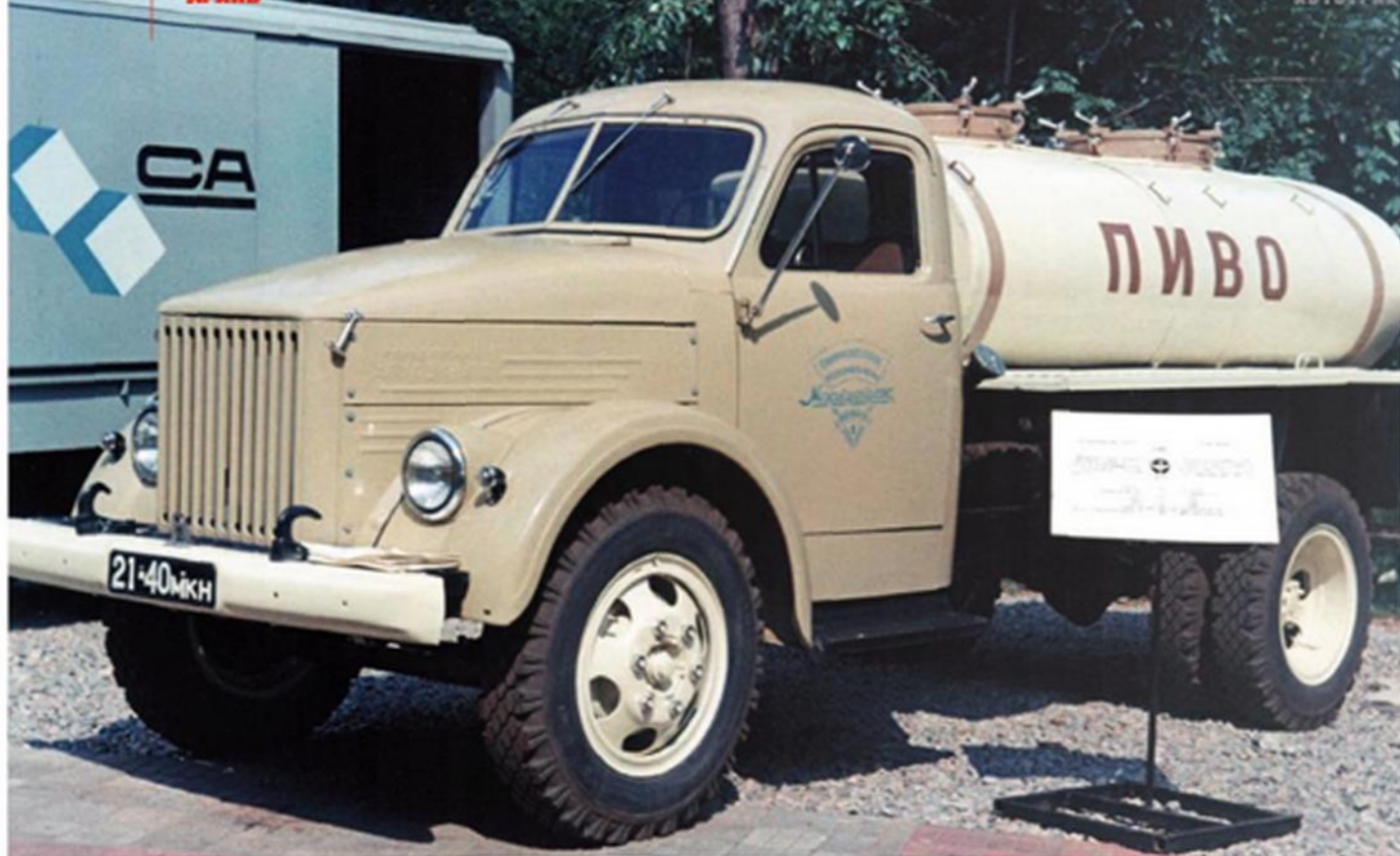
Автоцистерна Т-322 для транспортировки пива на шасси ГАЗ-51А, строившаяся на автокомбинатах «Мосавтотранс» с 1971 по 1975 гг.
