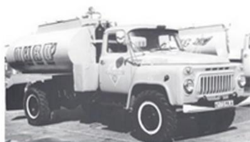
Пивные цистерны РЗ-ВЦЛ-3,3 на шасси ГАЗ-53А строились «Машиностроительным заводом имени Карла Либкнехта» с 1974 по 1988 гг.
