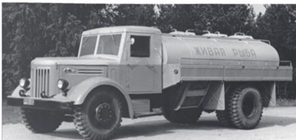
Автоцистерны для транспортировки живой рыбы АЦЖР-2,8 на шасси автомобиля повышенной проходимости ЗИЛ-157КЕ. Строились с 1966 по 1970 гг. «Прилужским заводом ППО».
