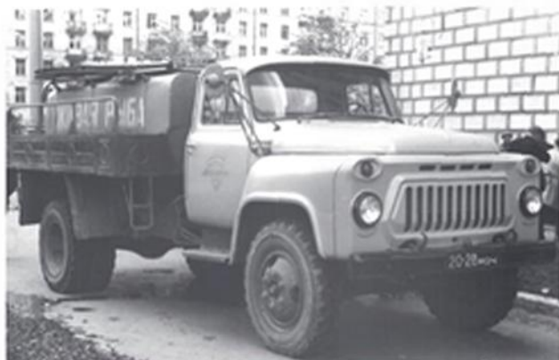
Автомобиль-цистерна АЦЖР-2,5-53 на шасси ГАЗ-53А для транспортировки живой рыбы, строилась Прилуцким заводом ППО с 1966 по 1980 гг.
