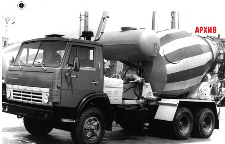
Автобетоносмеситель СБ-112-1 на шасси КамАЗ-5511 «Туймазинского завода автобетоновозов» экспонируется на выставке «Строительные машины и оборудование» на ВДНХ в 1981 г.
