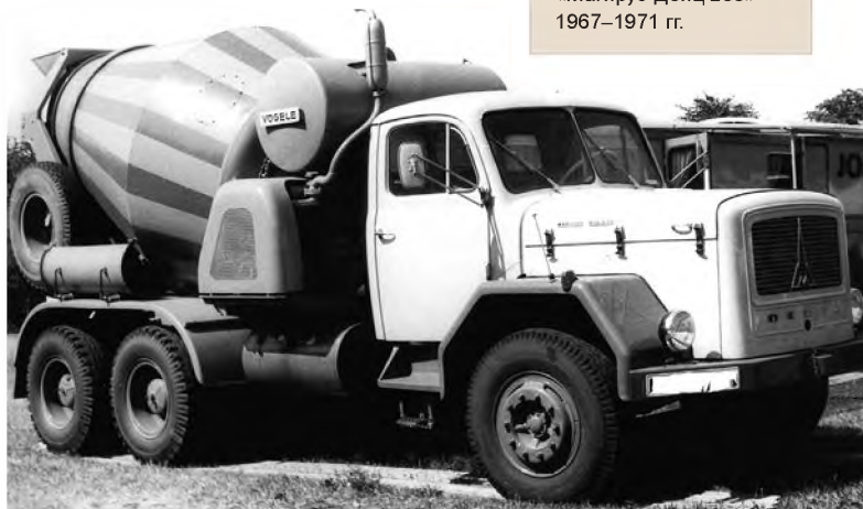
Тот же самый автобетоносмеситель «Фогель» ЭсЭл, только на шасси «Магирус-Дойц 230» 1967–1971 гг.
