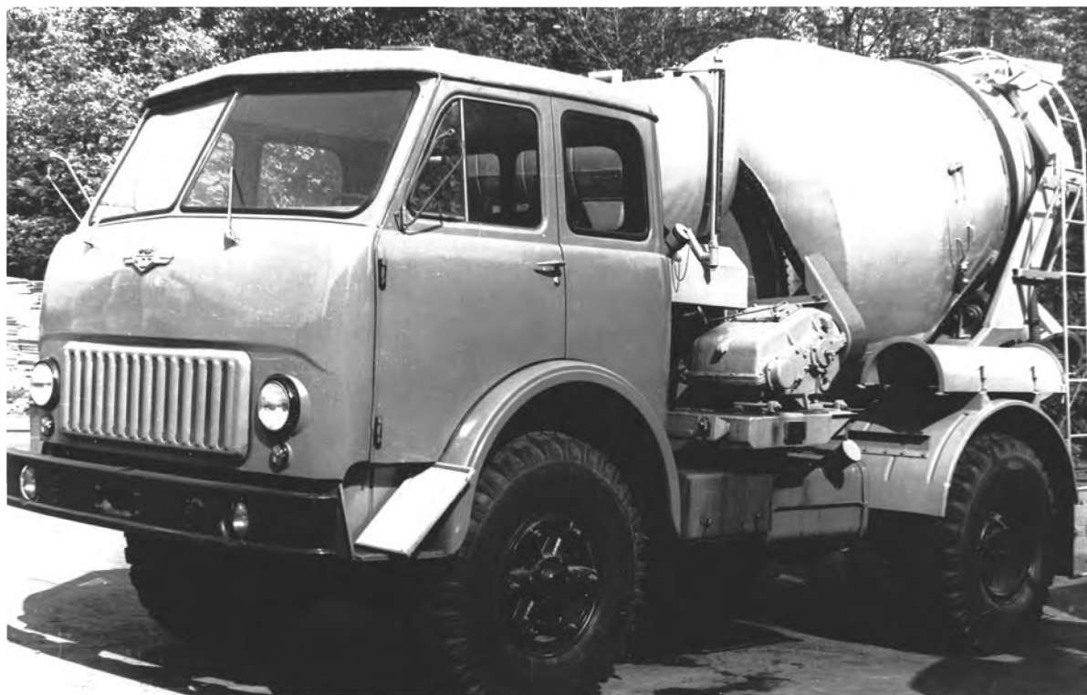
Опытный образец автобетономесителя С-1036 на шасси МАЗ-503 Славянского завода строительных машин экспонируется на ВДНХ в 1968 г.
