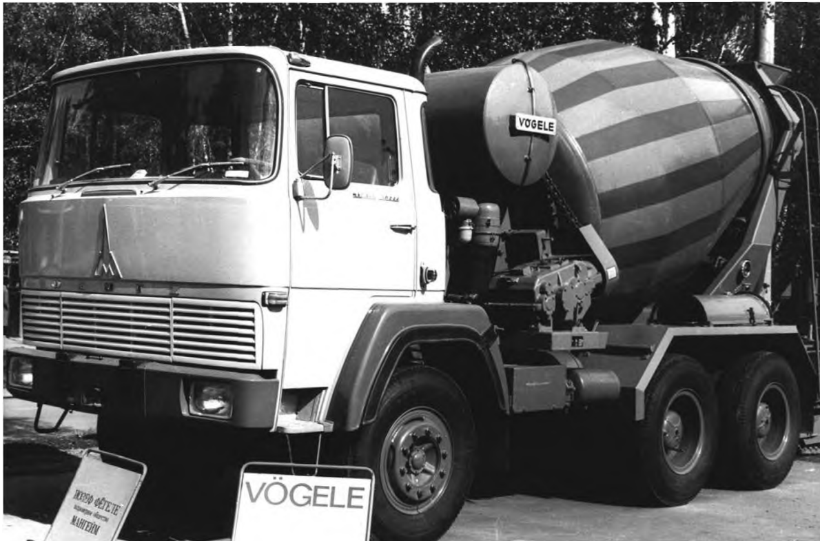
Автобетоносмеситель «Фогель» ЭсЭй на шасси «Магирус-Дойтц 230» с кабиной над двигателем. 1967–1970 гг.
