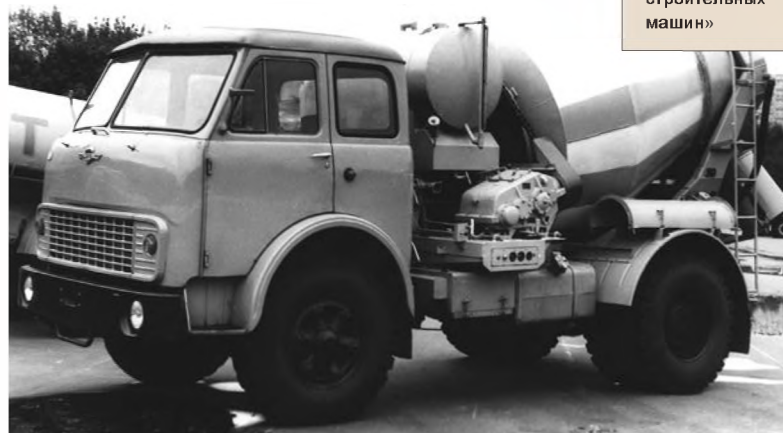
Модернизированный автобетономеситель С-1036 Б на шасси МАЗ-5335, выпускался с 1980 по 1988 годы «Славянским заводом строительных машин»
