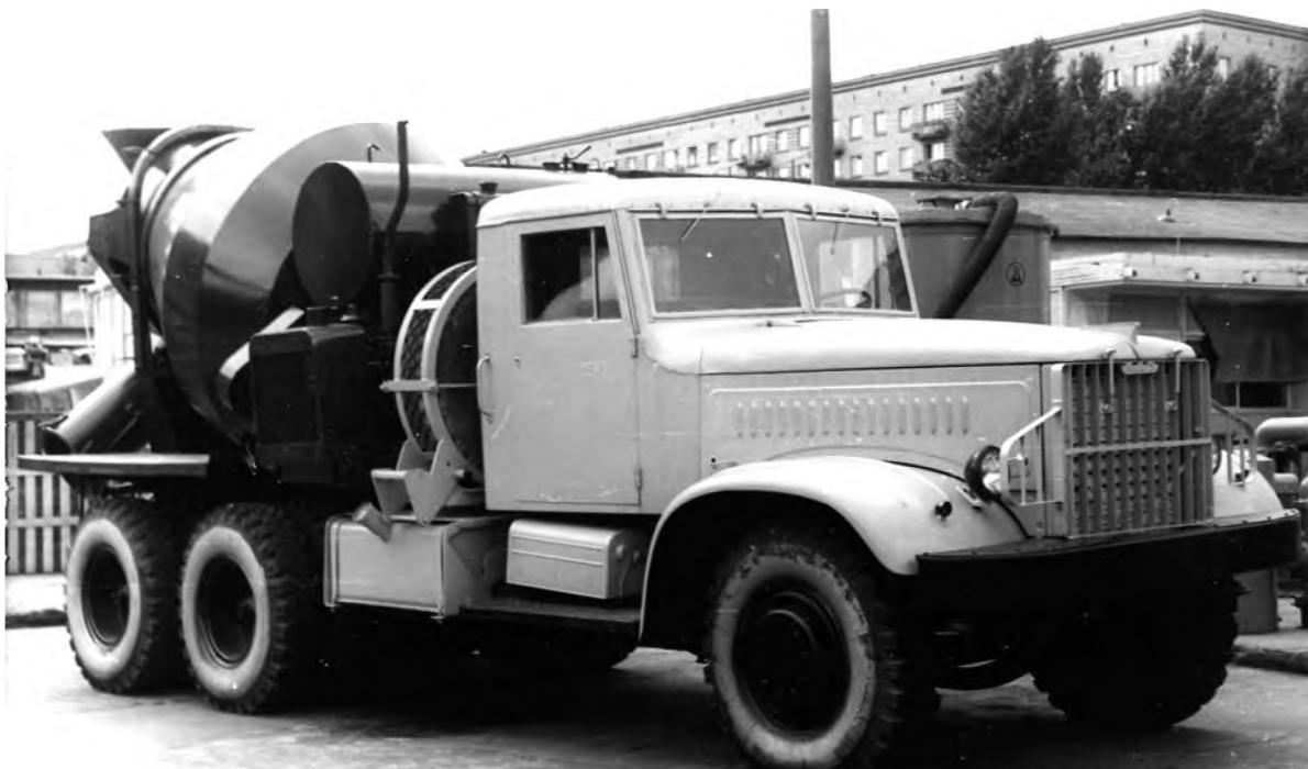
Опытный образец автобетоносмесителя С-942 на шасси КраЗ-222 Славянского завода строительных машин экспонируется в 1969 г. на «Строительной выставке» на Фрунзенской набережной.
