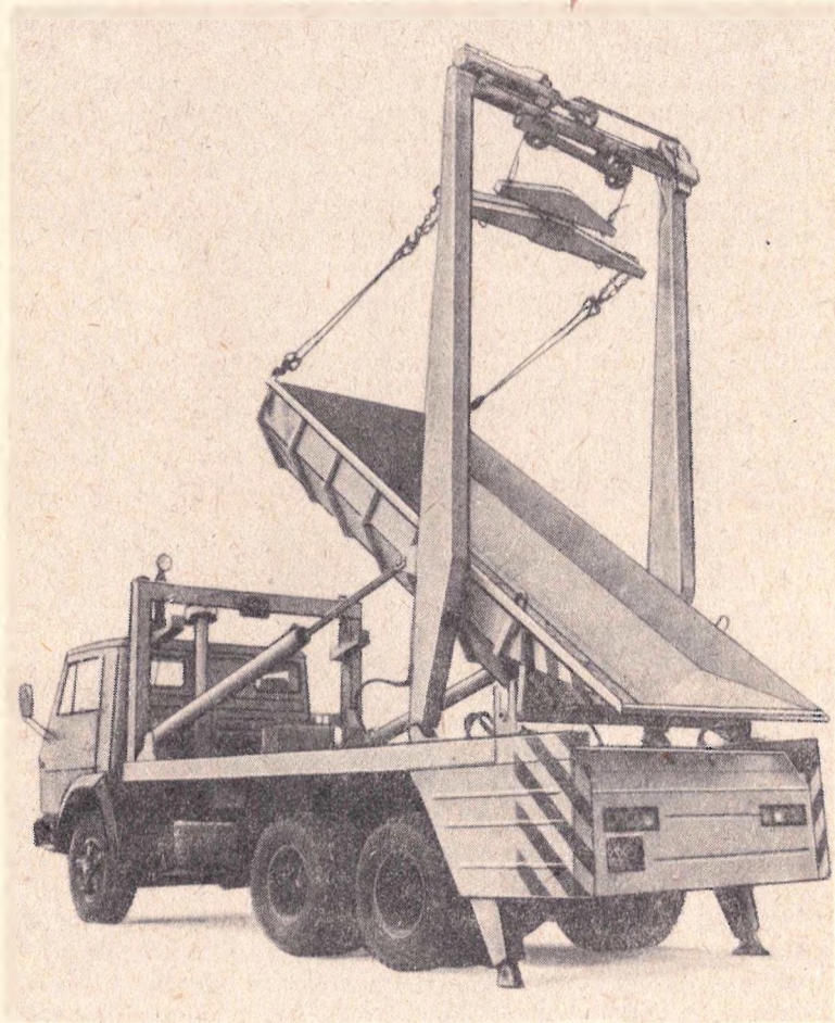
Рис. 21. Автомобиль КамАЗ-53212 с порталным устройством 5983 со съемным кузовом
