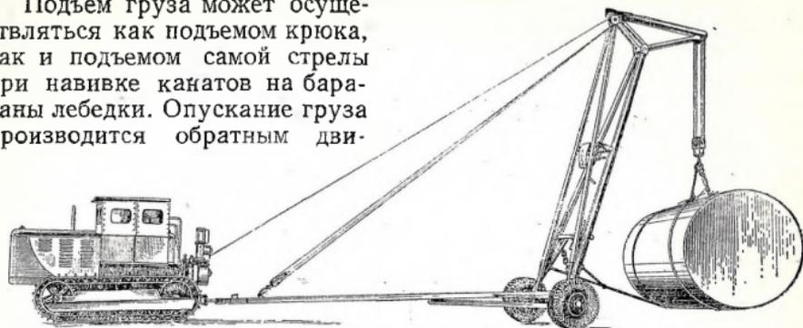
Фиг. 337. Тракторный кран 10-т прицепной Т-75 в работе.
