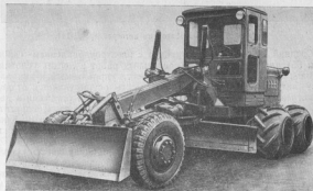
Фиг. 15. Легкий трехосный автогрейдер Д-446 с гидравлическим управлением и арочными шинами.
