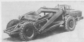
Фиг. 14. Самоходный скрепер Д-357Г с ковшем емкостью 9—11 м 3 .
