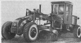
Фиг. 16. Средний двухосный автогрейдер Д-426 с гидравлическим управлением.
